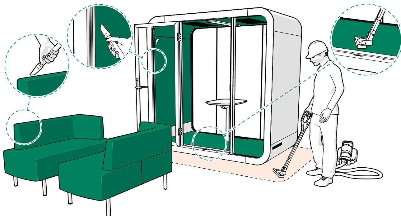
2. Nettoyez les surfaces suivantes avec un détergent universel à base d'alcool et un chiffon non pelucheux.
