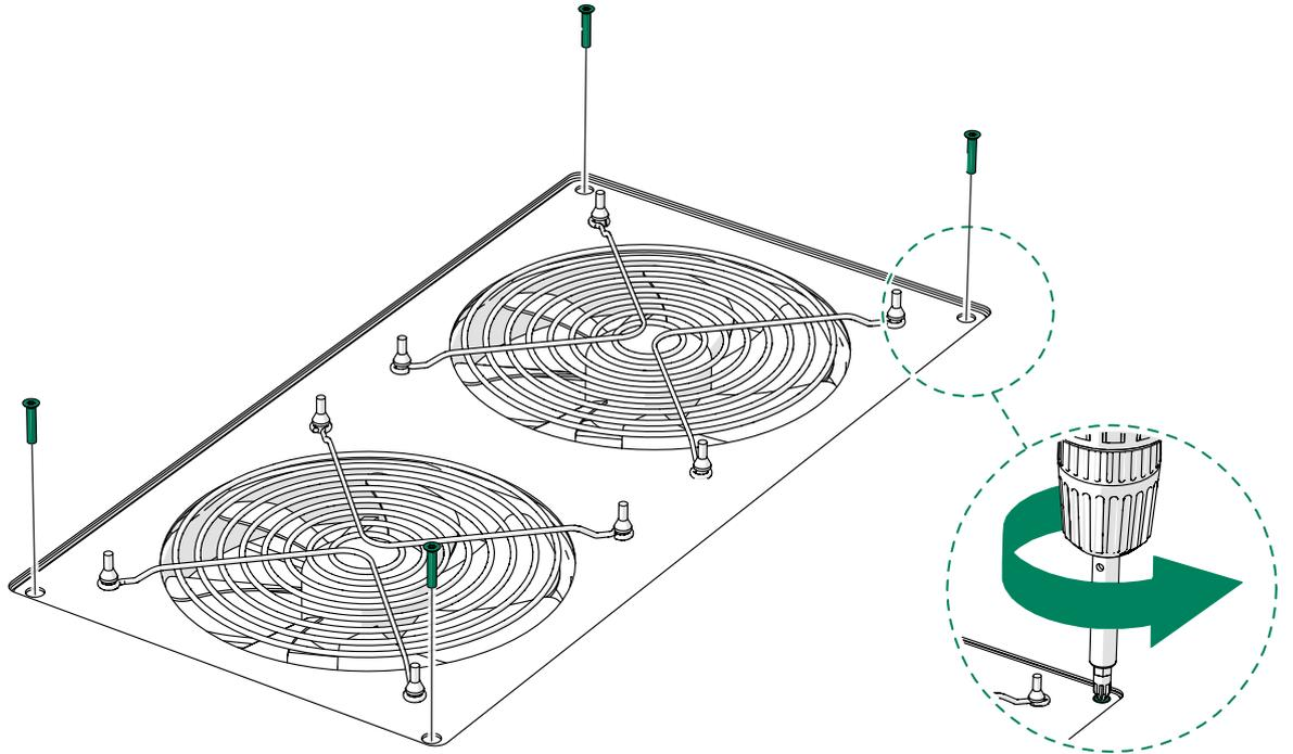
2. Soulevez le module de ventilation pour le dégager du module de toit et débranchez les connecteurs d'alimentation CC.
