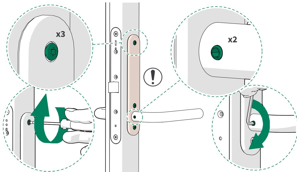
2. Serrez les vis sur le boîtier.
