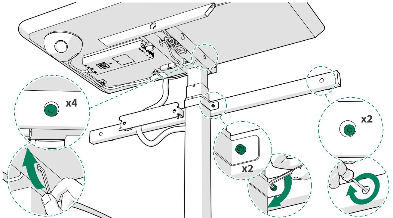
3. Serrez les vis du support d'installation de la table. (Framery Q fonctionnant avec PAL).
