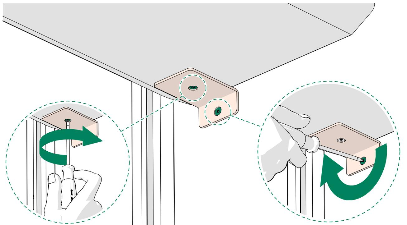
4. Soulevez la moquette et serrez les vis de l'embase de la table. vis fraisées M6x20 et vis 5x50.
