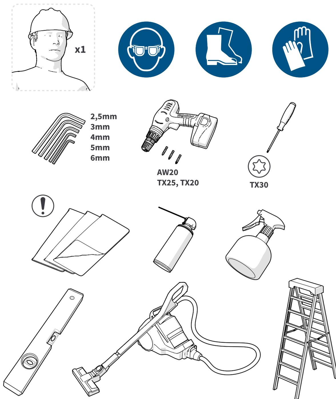
Figure 1: Les outils et les accessoires sont nécessaires à l'installation et à la maintenance
