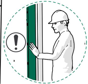
5. Installez le cadre gauche avec 2 boulons M8x35 et 2 rondelles M8.
