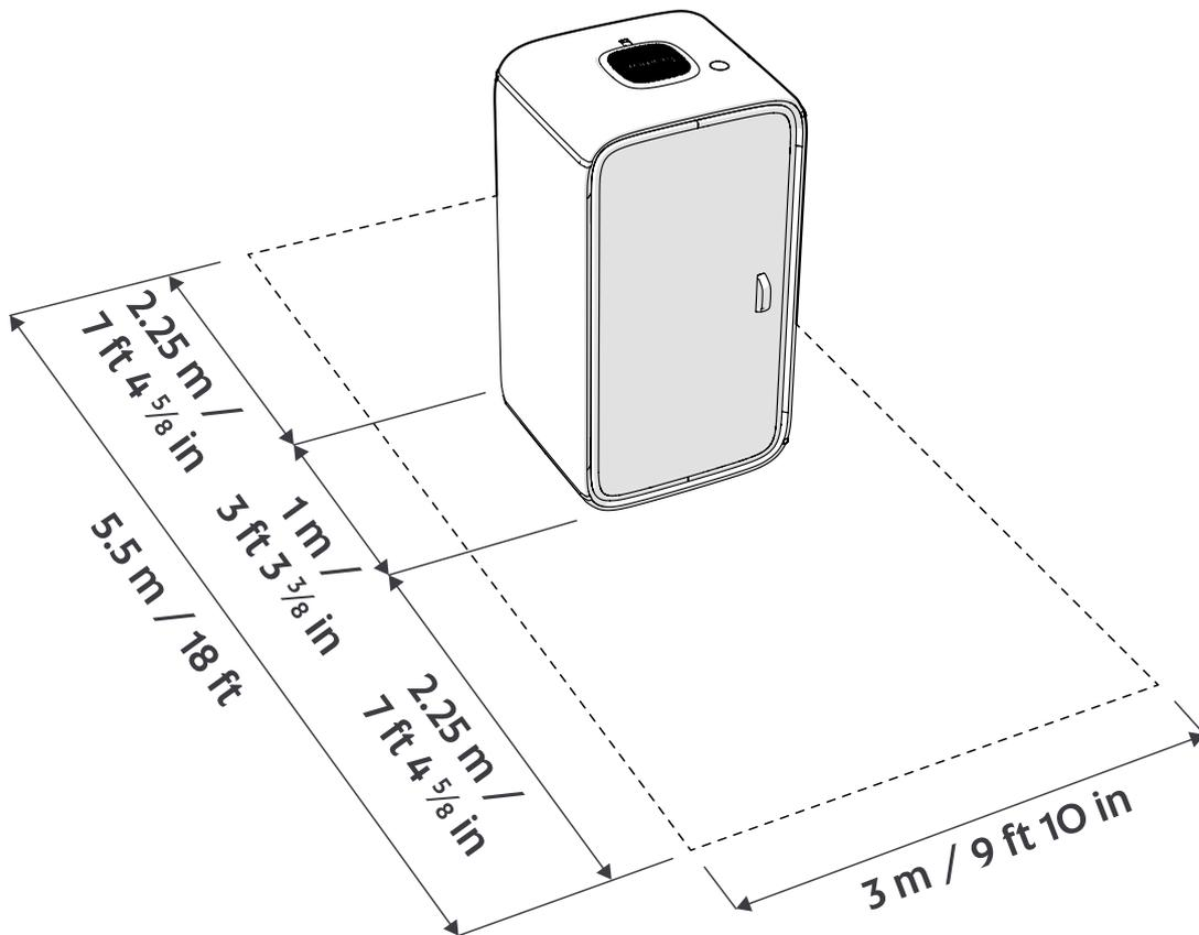
Illustration 8 : Espace de fonctionnement nécessaire pour l'installation des ancrages parasismiques
