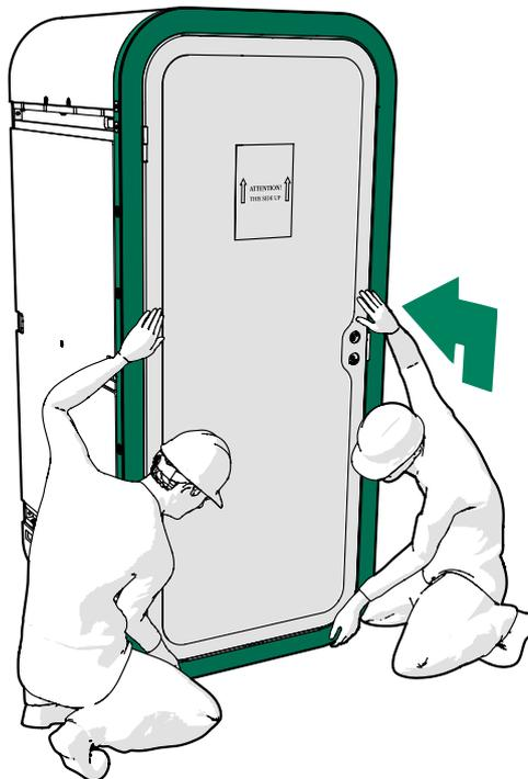
4. Soutenez le bâti de la porte et installez-le à l'aide de boulons M8x35 (6 unités) et de rondelles M8 (6 unités). Serrez les boulons à la main.
