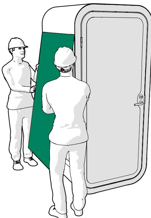
2. D'une main, exercez une pression sur le revêtement pour le faire entrer dans la rainure supérieure et de l'autre main, courbez le revêtement légèrement vers l'extérieur. Faites glisser le bord inférieur du revêtement dans la rainure en bas de la paroi et exercez une pression pour mettre le revêtement en place.
