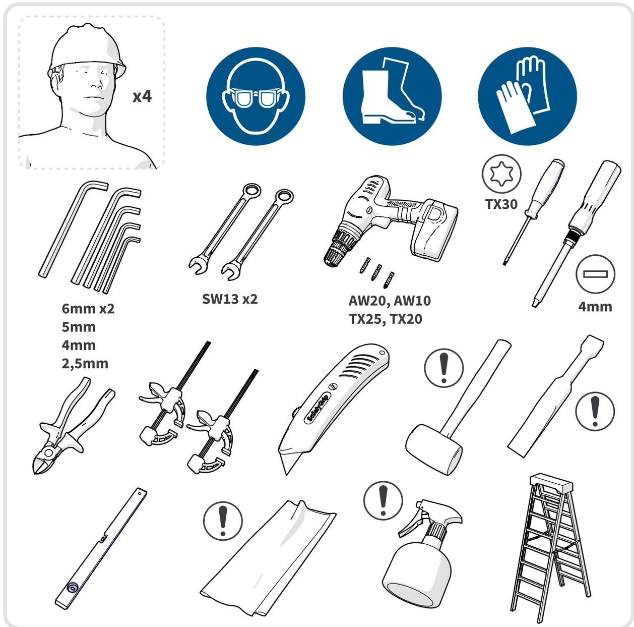
Illustration 1 : Outils et accessoires nécessaires à l'installation
