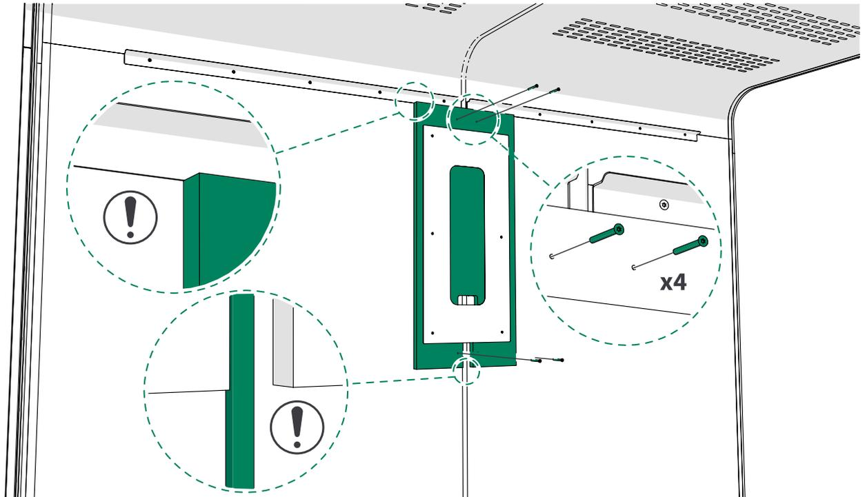
4. Placez les 2 aimants en dessous de la plaque arrière en bois. Mesurez une distance d'écartement de 45 mm (1 ¾ pouce) entre le joint du profilé en U et le trou de la vis dans l'aimant et utilisez 2 vis 4x40 pour la fixation.
