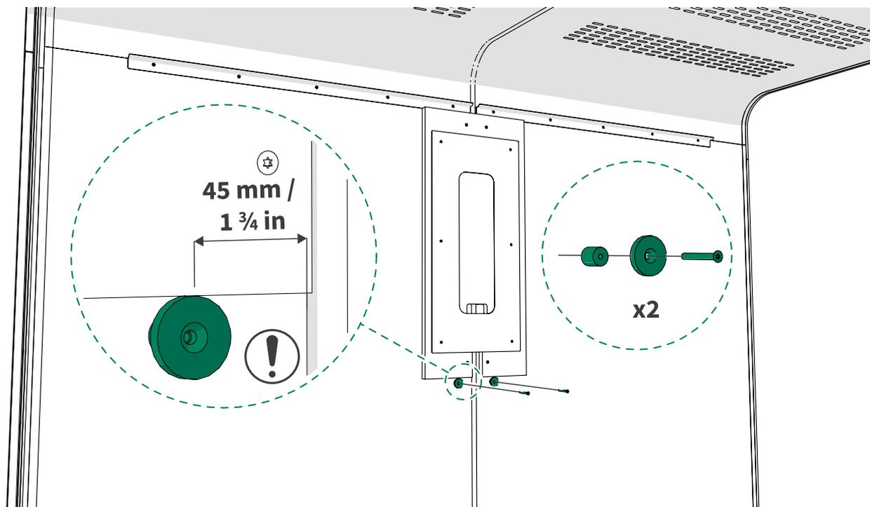
5. Mettez en place les 2 aimants destinés aux bords extérieurs du tableau blanc. Mesurez une distance d'écartement de 1150 mm (3 pieds 9 ¼ pouces) entre le joint du profilé en U et le trou de la vis dans l'aimant et utilisez 2 vis 4x40 pour la fixation. Installez les aimants avec des entretoises en plastique de 15 mm sur le feutre mural.
