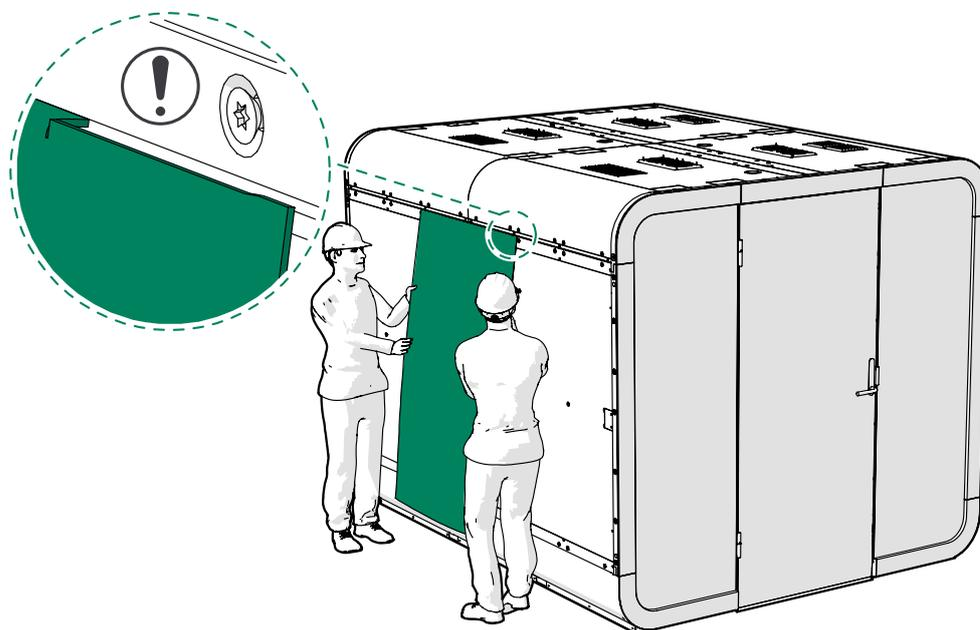
2. D'une main, exercez une pression sur le revêtement pour le faire entrer dans la rainure supérieure et de l'autre main, courbez le revêtement légèrement vers l'extérieur. Faites glisser le bord inférieur du revêtement dans la rainure en bas de la paroi et exercez une pression pour mettre le revêtement en place.
