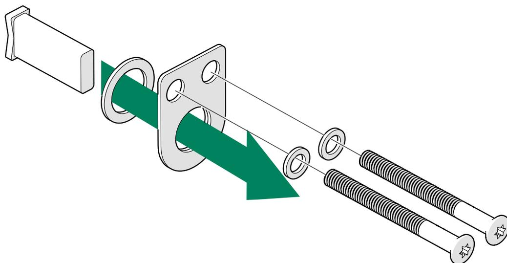
5. Assemblez le cylindre de la serrure connectée et l'écusson du cylindre.
