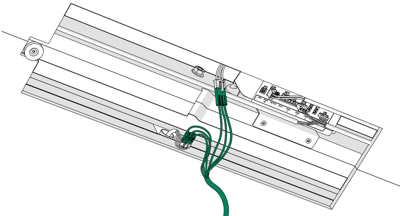
5. Raccordez la rallonge courte pour la ventilation au connecteur FAN 1 de l'unité de commande.
