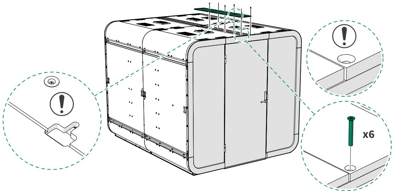
2. Installez le panneau de revêtement du toit sur la demi-partie arrière du toit à l'aide de 6 vis 4x30.
