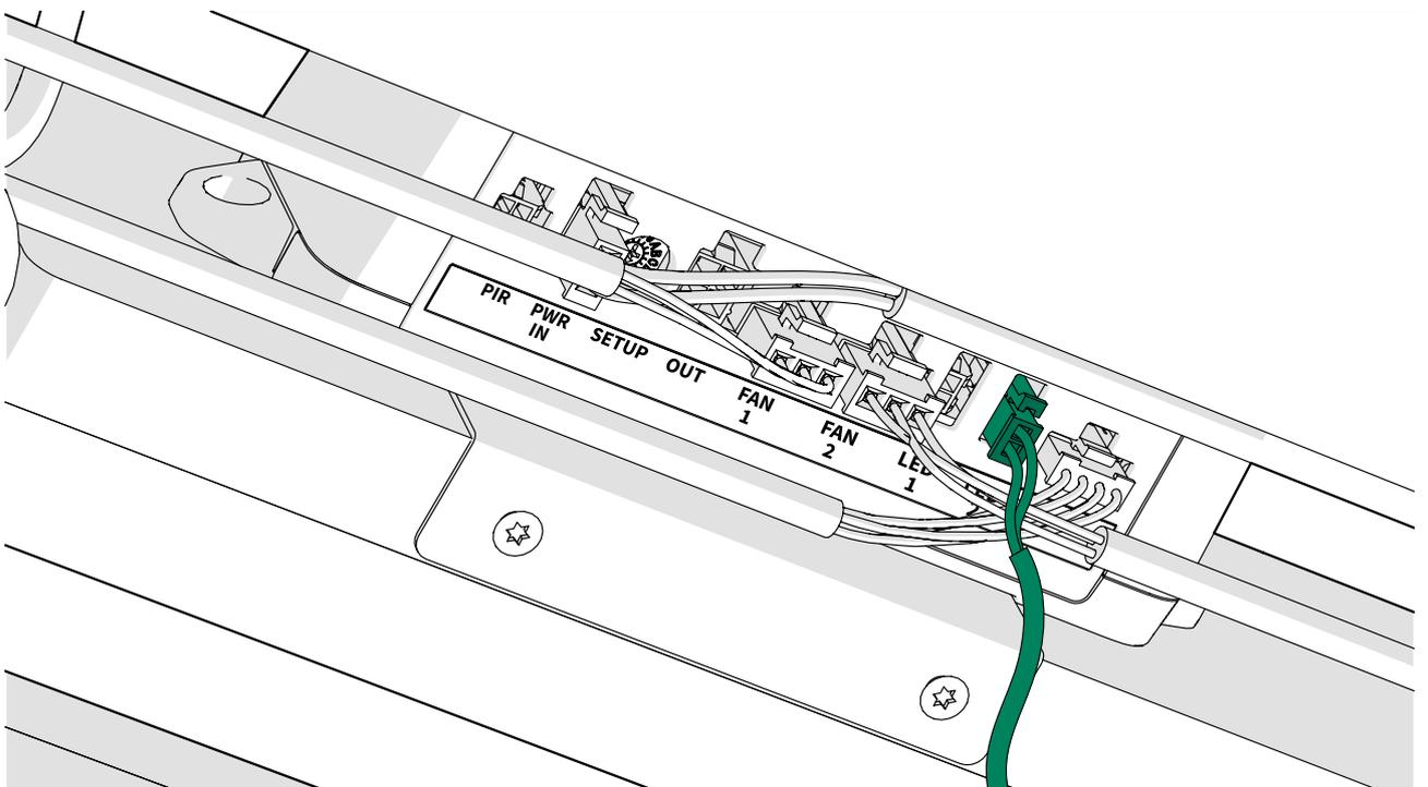
7. Acheminez le câble prolongateur de l'éclairage depuis l'avant de la cabine jusqu'à l'arrière et faites-le sortir de l'ouverture prévue pour l'éclairage.
