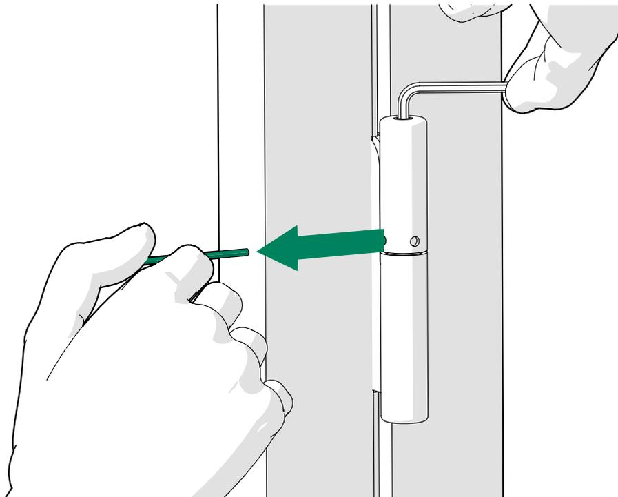
7. Tournez la clé hexagonale d'un quart de tour et insérez l'ergot d'arrêt dans le trou situé sur le côté gauche du gond proche du dormant de la porte.
