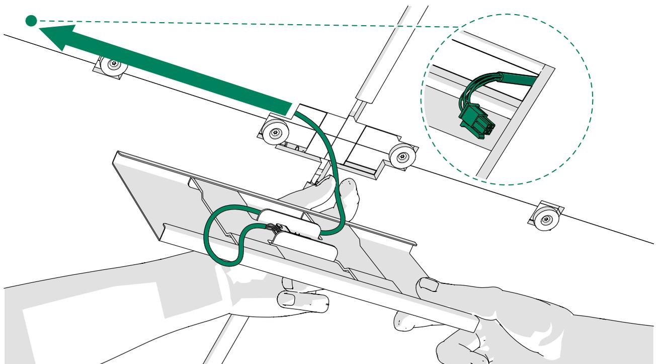
2. Raccordez le cordon d'alimentation CC du détecteur de mouvement au connecteur PIR de l'unité de commande.
