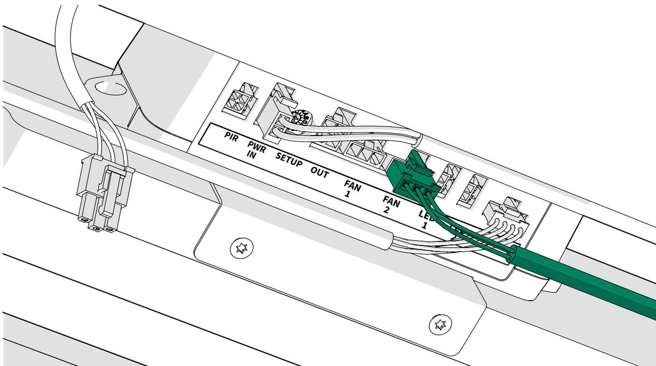
4. Raccordez les cordons d'alimentation CC des ventilateurs à la rallonge courte prévue pour la ventilation à l'avant.
