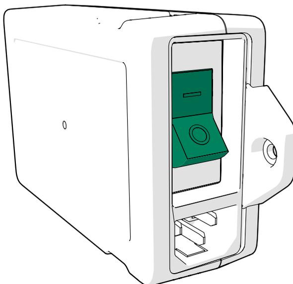
8. Fixez la boîte métallique et ses branchements électriques sur le dessous du plateau de la table à l'aide de 4 vis 4x20.
