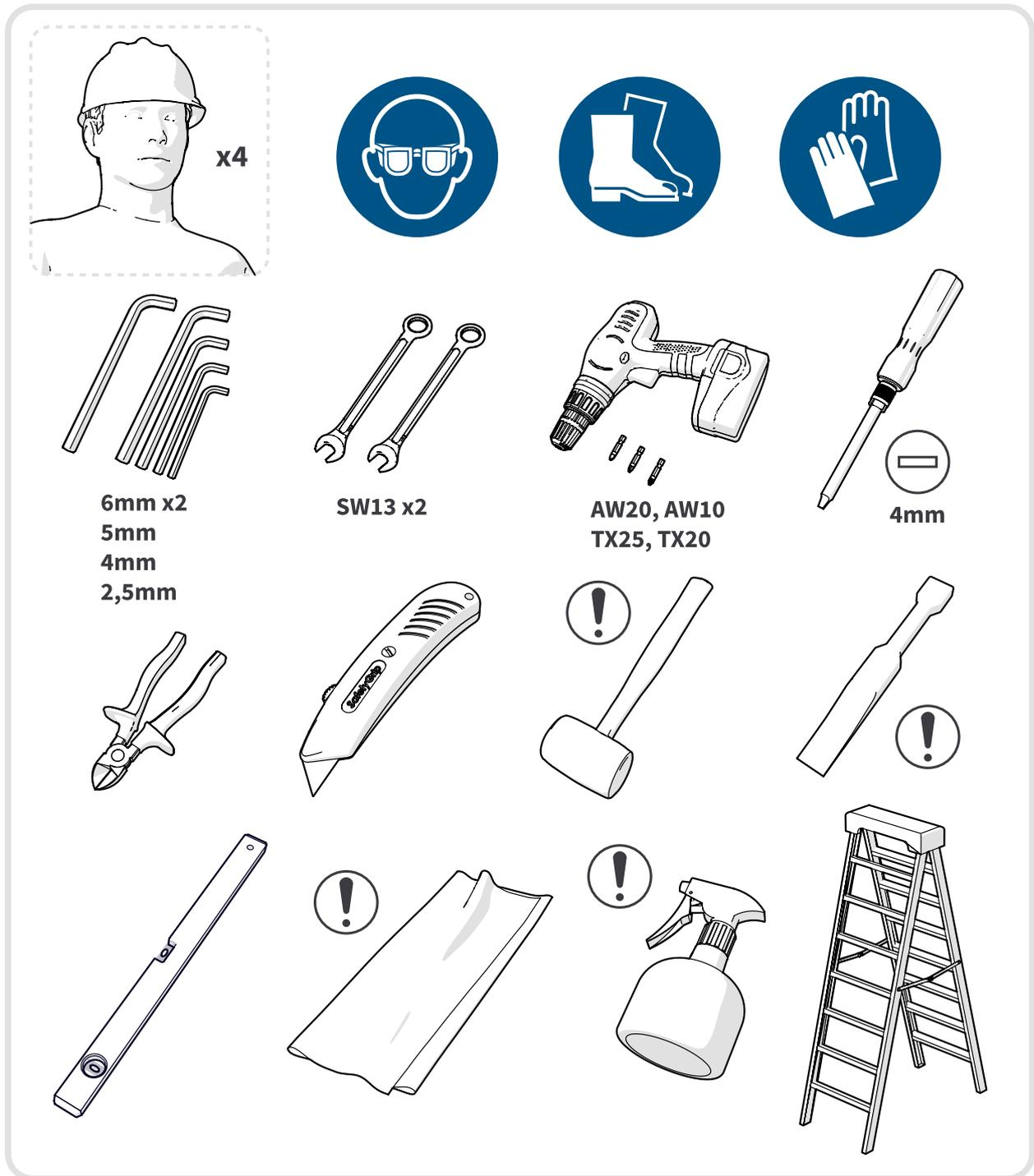
Illustration 1 : Outils et accessoires nécessaires à l'installation et à la maintenance
