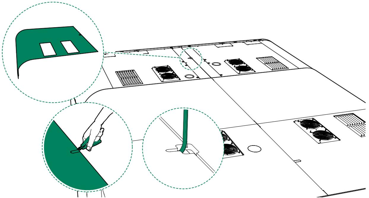
3. Installez les 2 revêtements de structure du toit respectivement sur le coin gauche à l'arrière et le coin droit à l'avant du toit.
