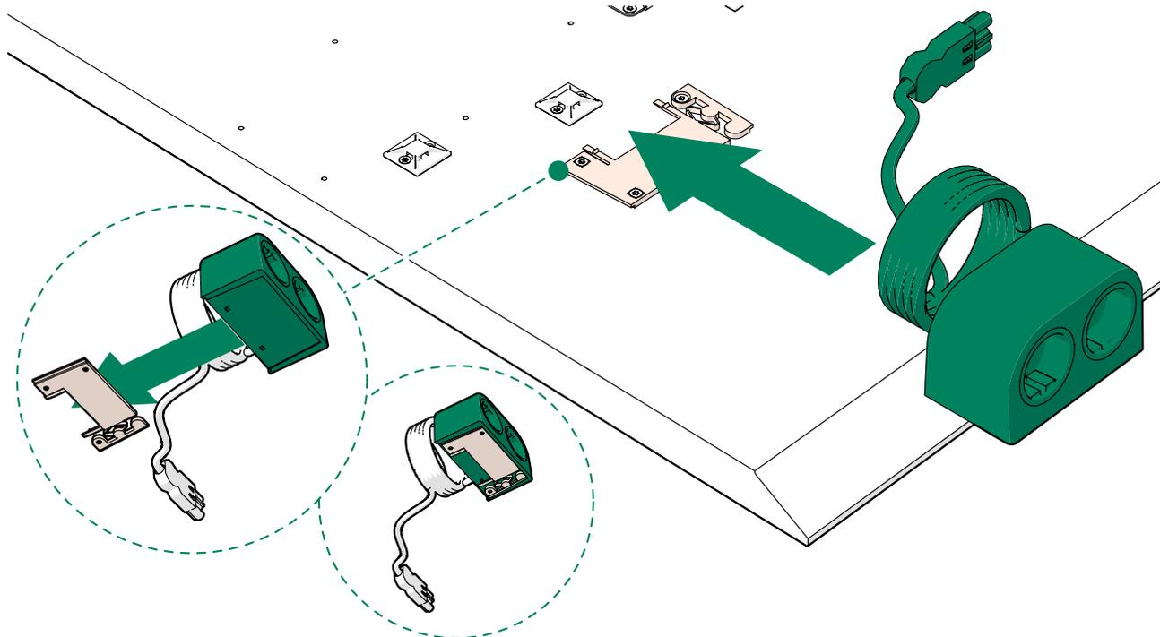
3. Enroulez la longueur restante du câble pour former une boucle que vous attacherez à l'aide d'une attache de câble.
