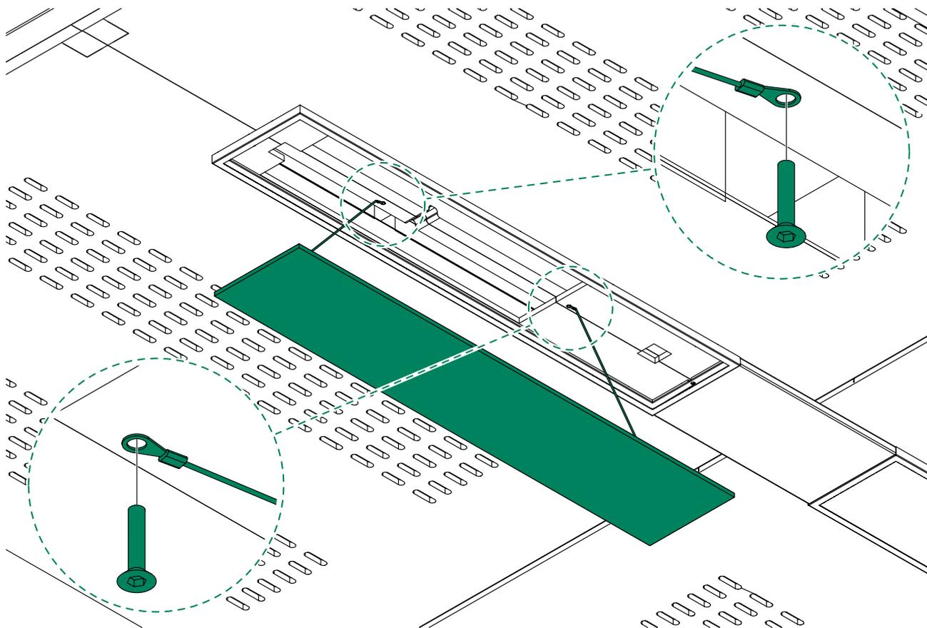
6. Fixez l'éclairage sur le plafond de la demi-partie avant, en le disposant bord à bord du détecteur de mouvement.
