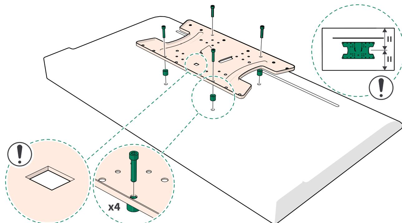
4. Installez l'embase du support d'écran sur la paroi gauche avec 4 vis 4x40.
