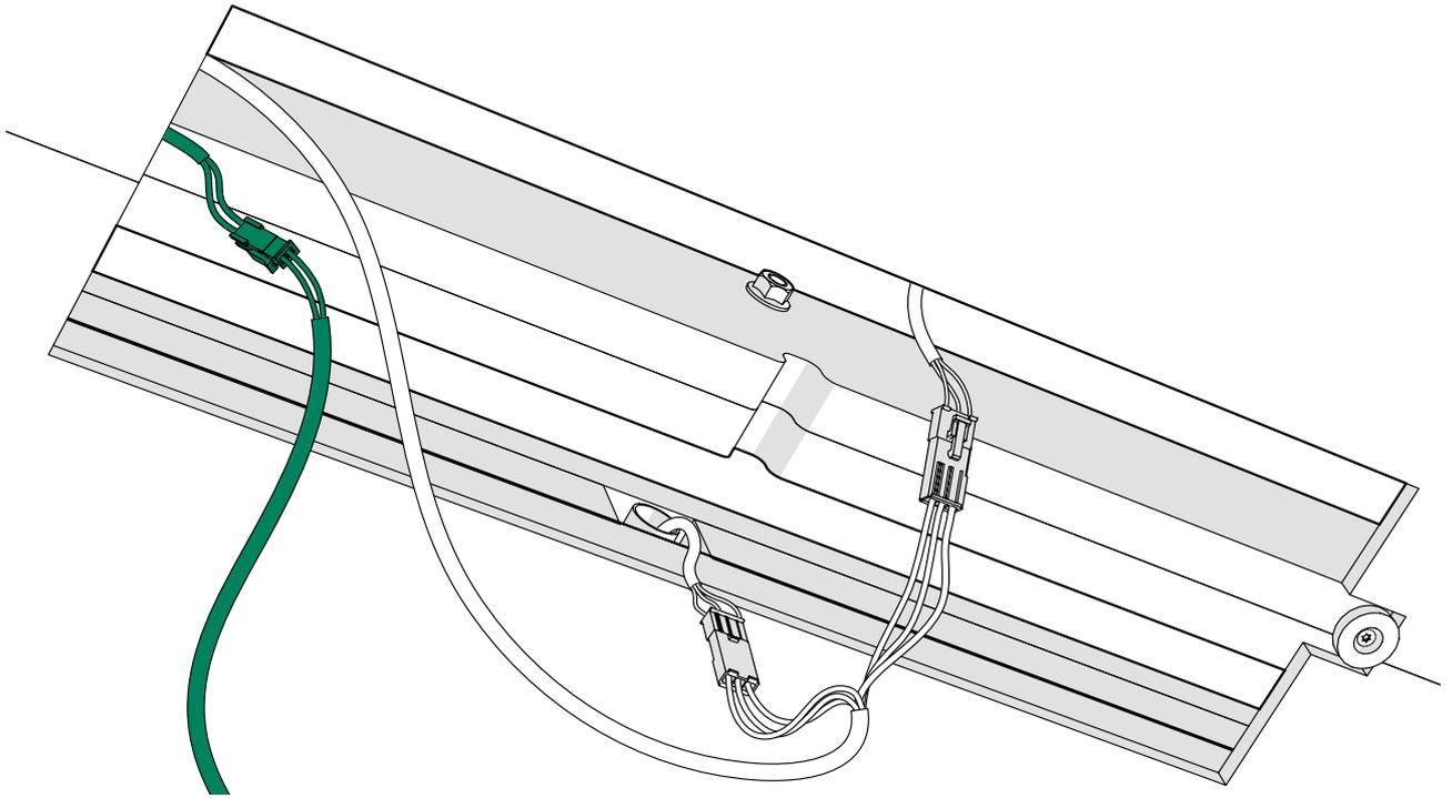
2. Installez les fils de l'éclairage sur le toit avec 4x20 vis.
