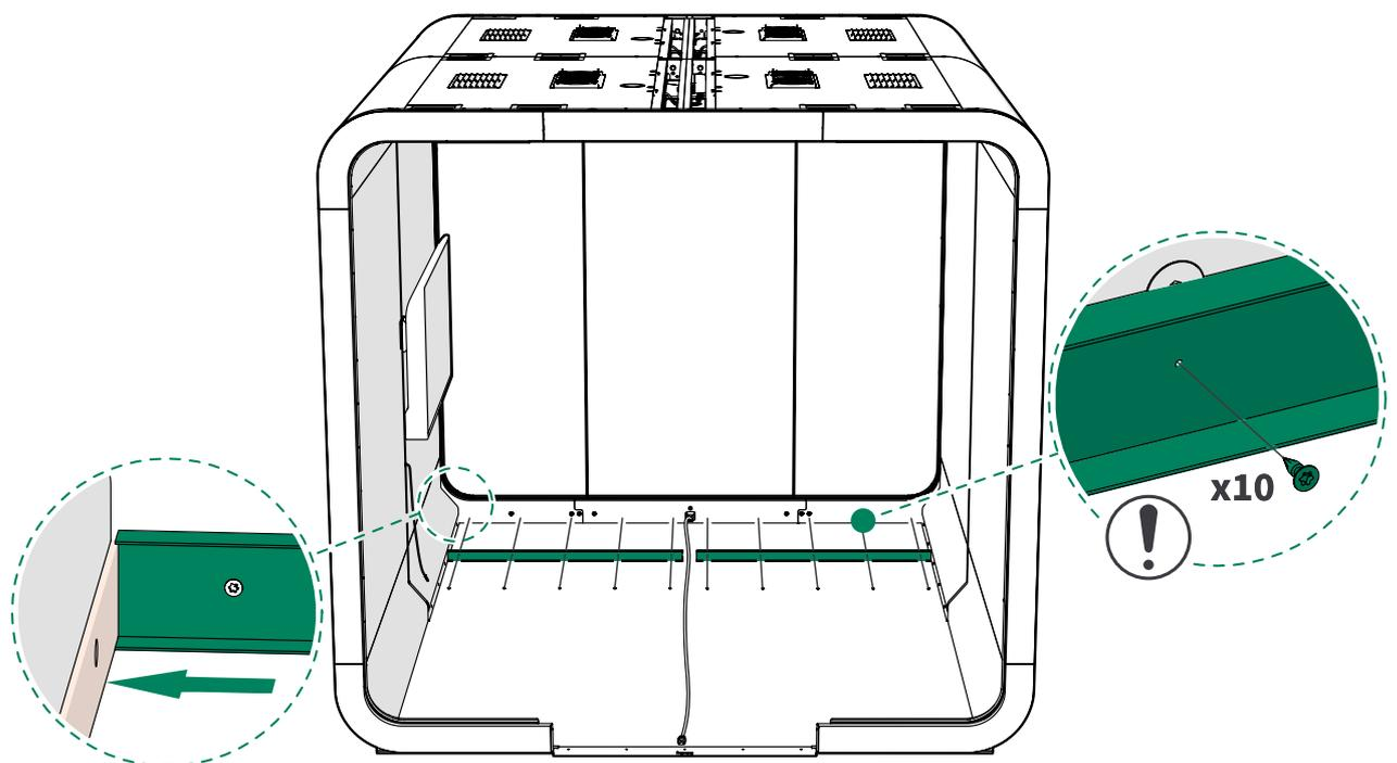
4. Montez d'abord les garnitures métalliques noires sur la paroi de droite en utilisant des vis fraisées noires 5x50. Puis montez le profilé arrière de la goulotte de câblage ainsi que les garnitures métalliques noires sur le paroi de gauche avec des vis fraisées noires 5x50.
