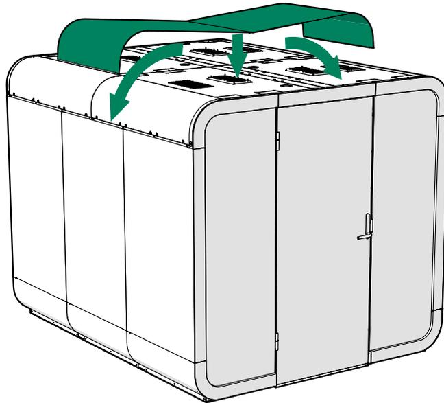
2. Si vous avez installé le câble d'alimentation par le toit, découpez l'encoche pour la retirer du revêtement de structure.
