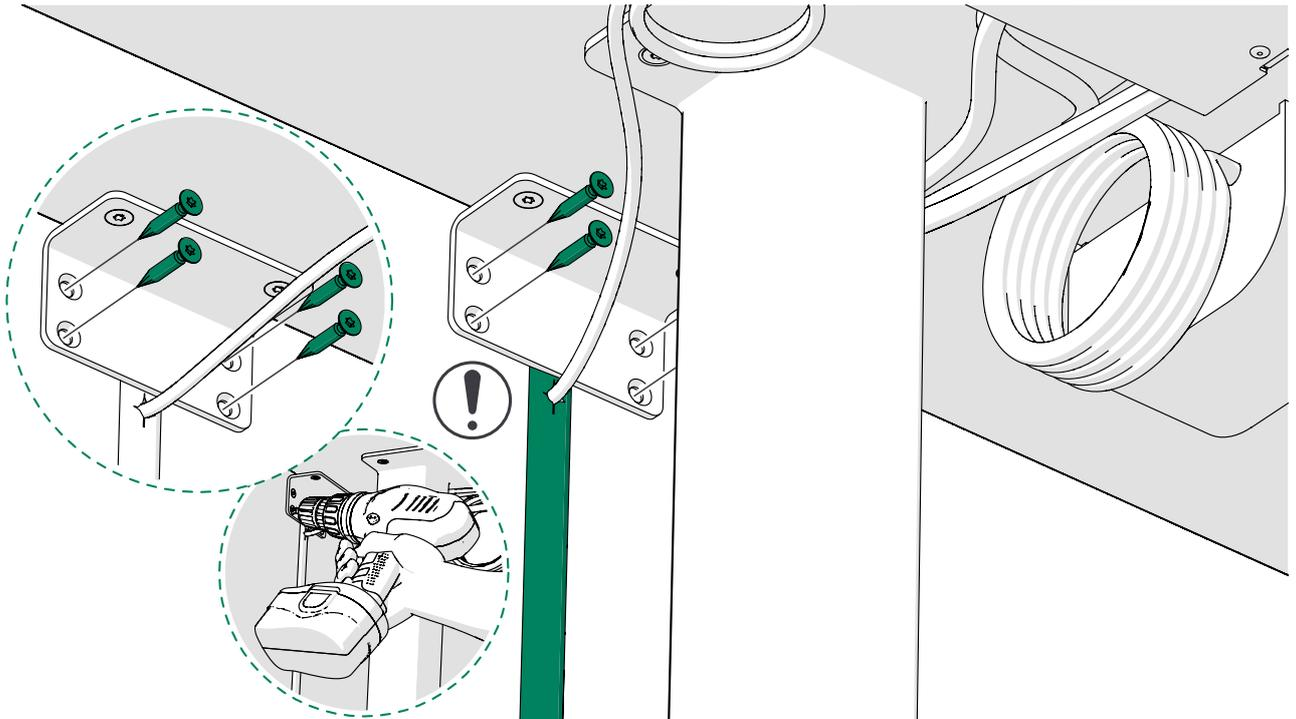
8. Faites passer les attaches de câble à travers les 5 étriers de câble et maintenez en place la longueur restante du câble avec les attaches de câble sous le plateau de la table.
