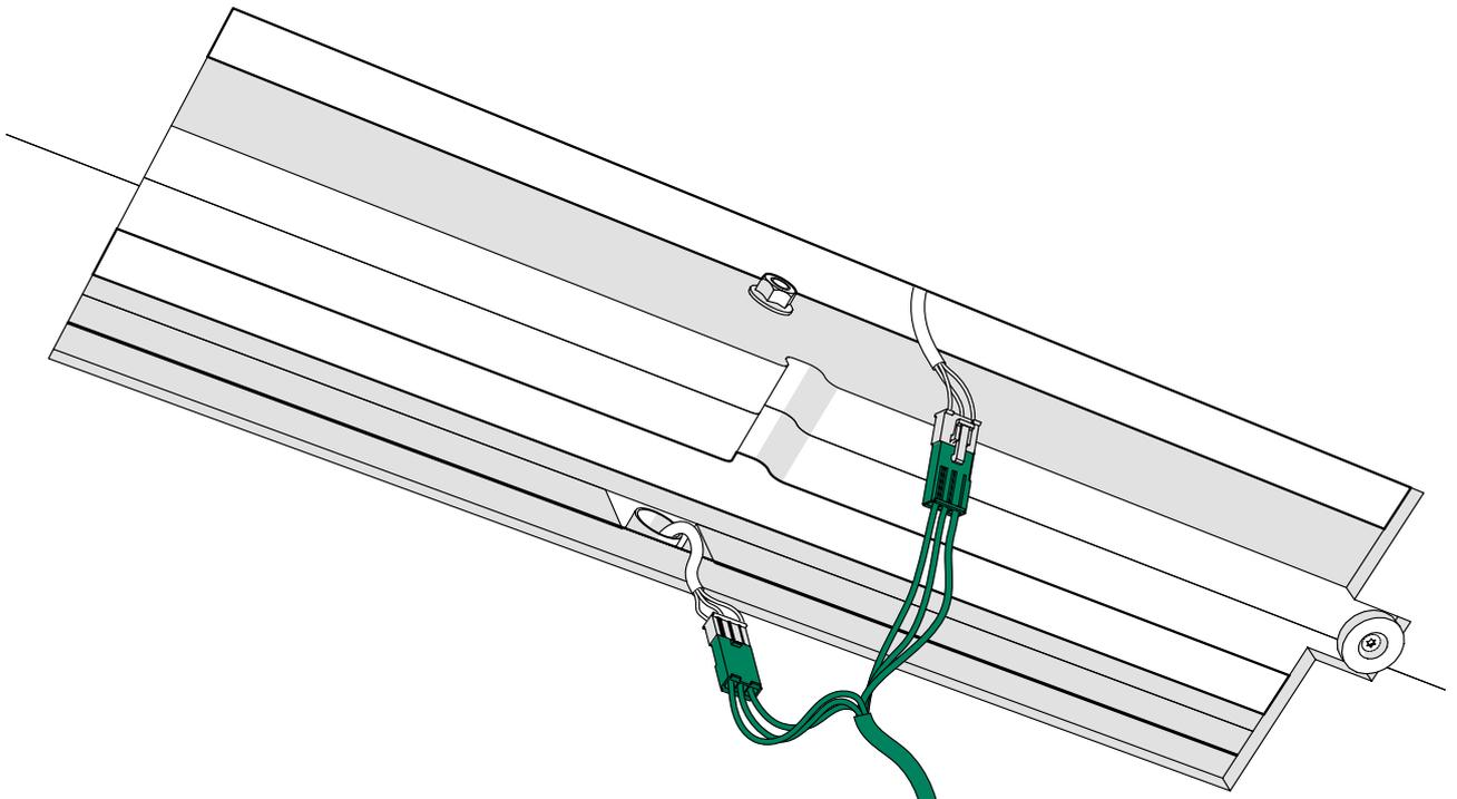
2. Acheminez la longue rallonge d'alimentation de la ventilation depuis la partie arrière de la cabine jusqu'à la rainure dans la poutre centrale, puis dans la cabine à travers l'ouverture à l'avant prévue pour l'éclairage.
