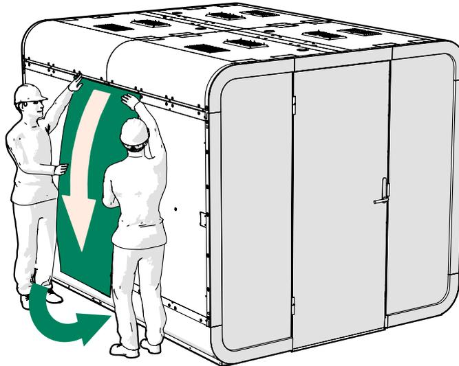
3. Installez les revêtements de la structure murale (2 de chaque côté) sur les côtés du mur de la cabine.
