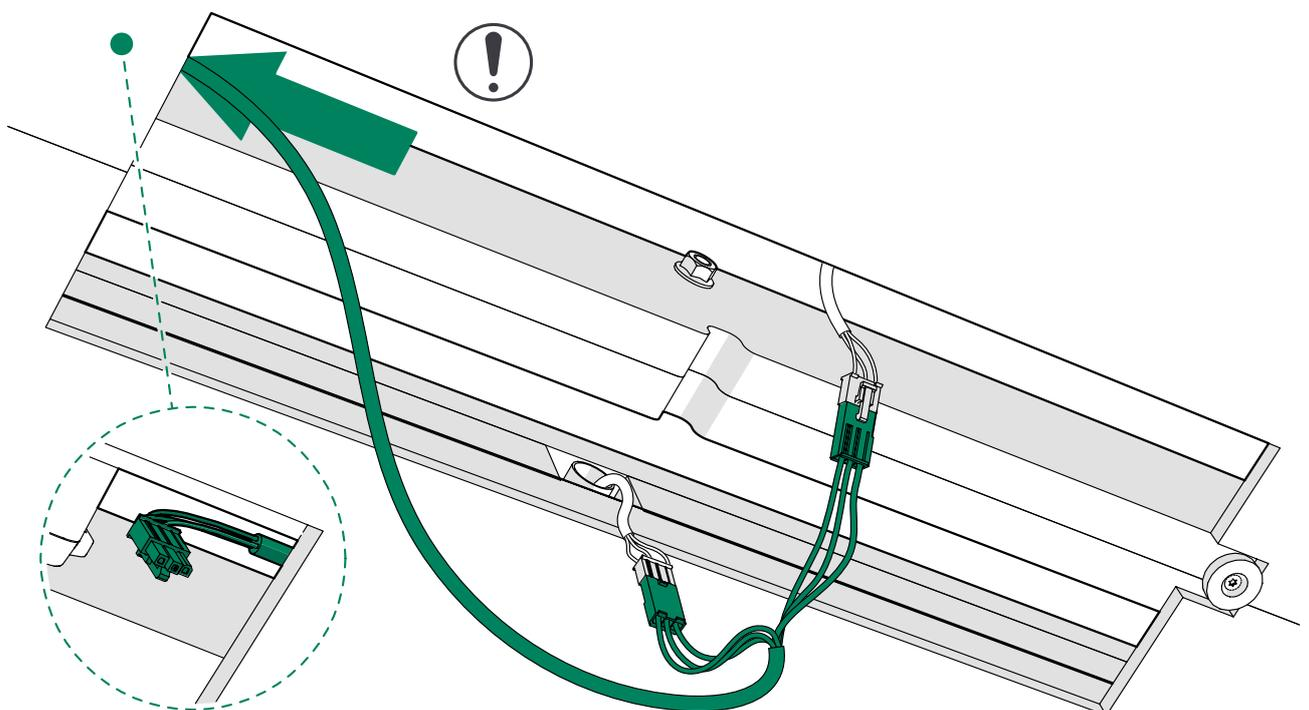
3. Raccordez la rallonge longue d'alimentation de la ventilation au connecteur FAN 2 de l'unité de commande.
