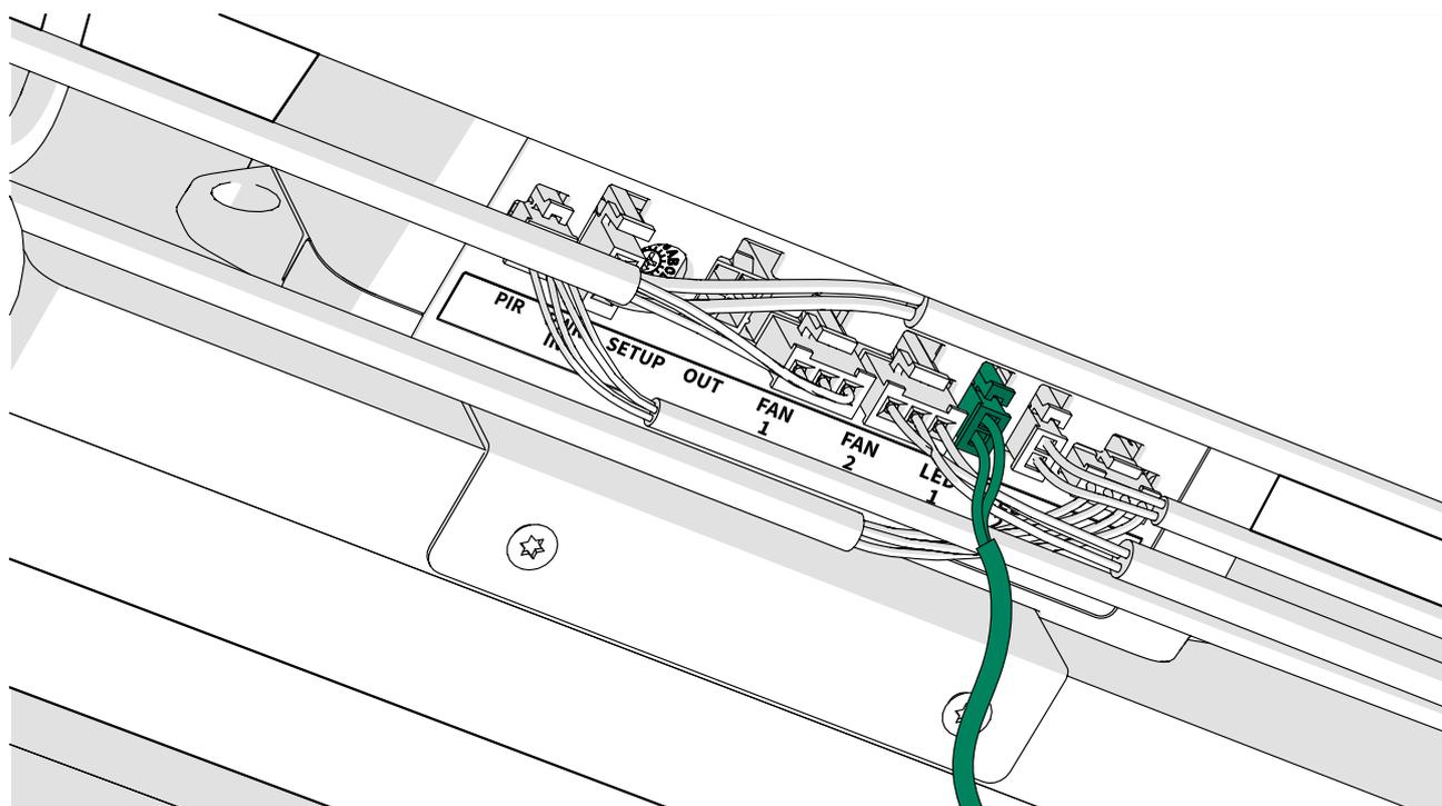
5. Installez les fils de l'éclairage sur le toit avec 4x20 vis.
