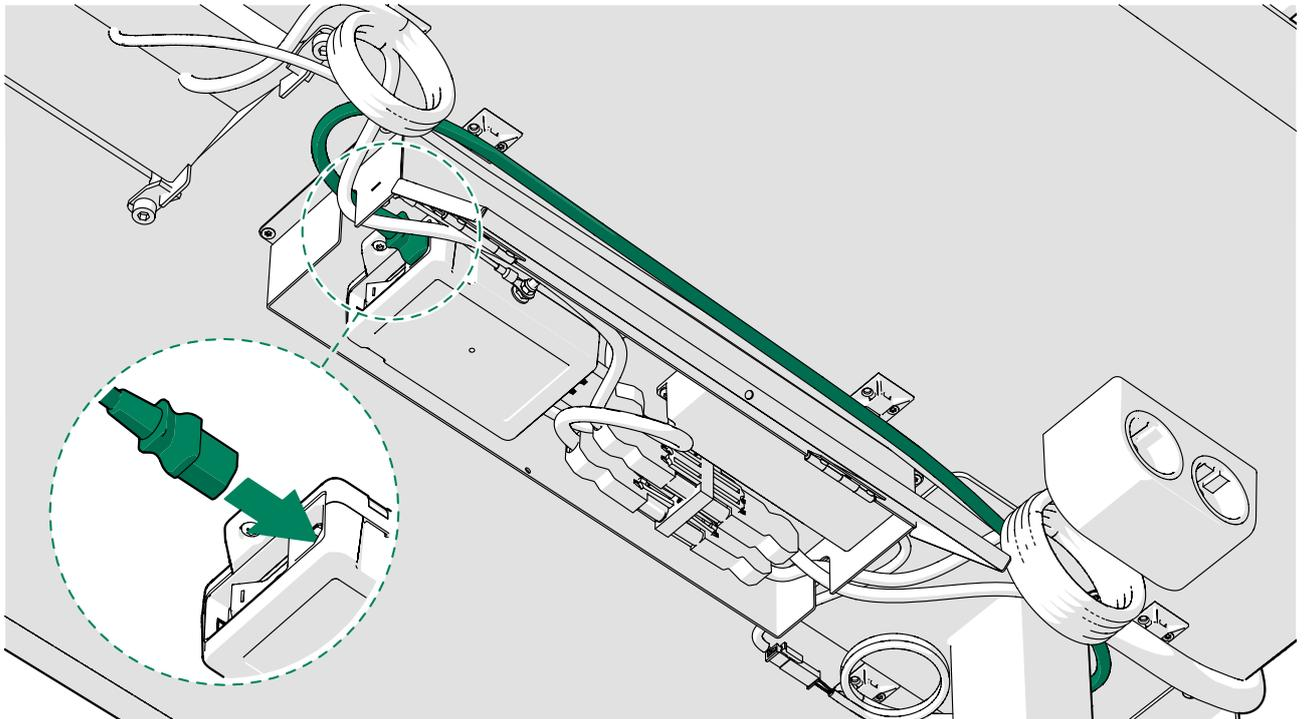
5. Fermez le couvercle de la boîte métallique et insérez la vis M4x6.
