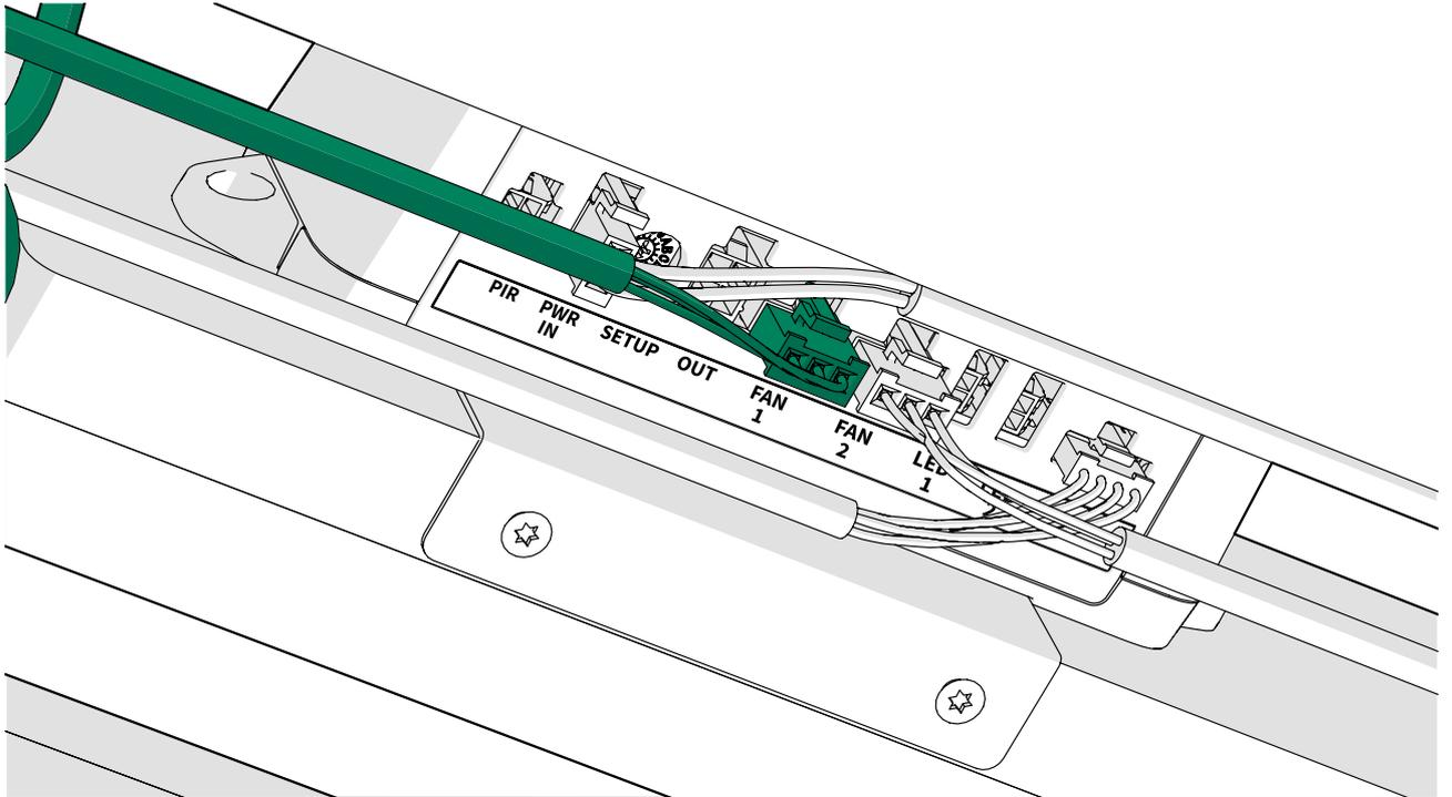
6. Raccordez la rallonge prévue pour l'éclairage au connecteur LED 2 de l'unité de commande.
