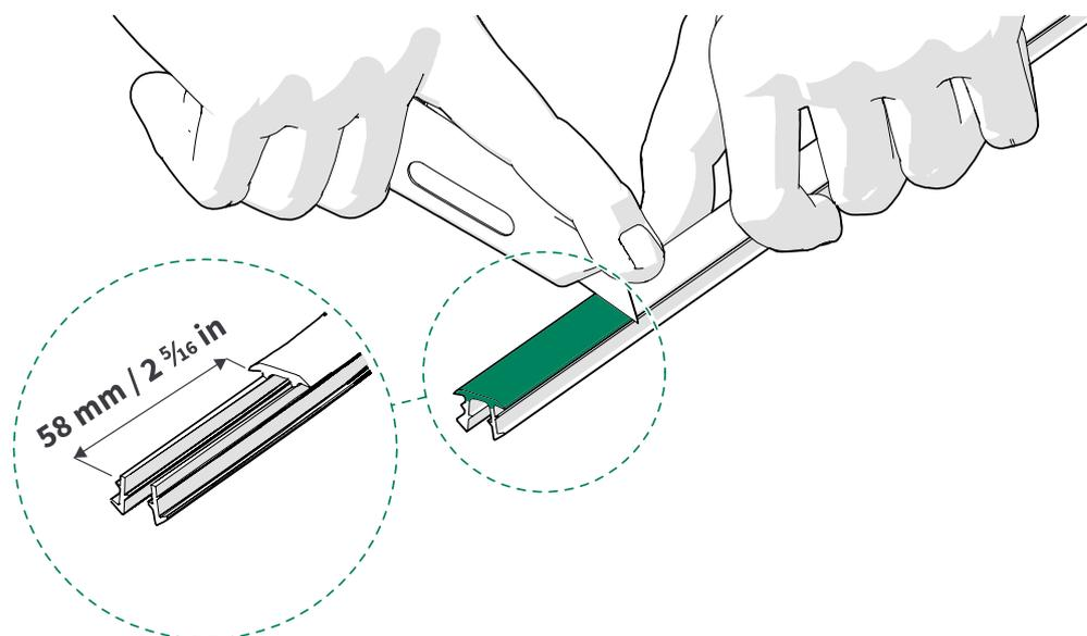
2. Mettez en place le joint sur le profilé en U sur le côté droit de la cabine en partant du plafond pour aller jusqu'au sol.
