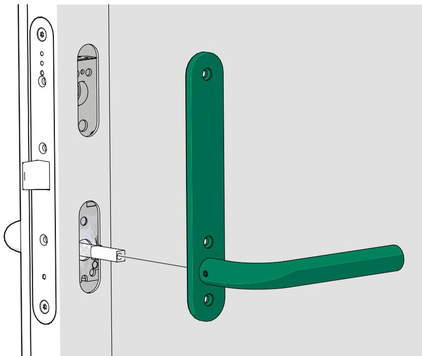
4. Insérez une vis M5x46 dans le trou au centre de la poignée depuis la partie intérieure de la porte.
