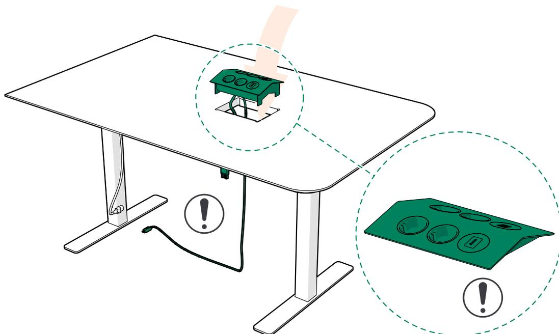
2. Insérez les éléments de fixation dans les fentes en dessous de la prise de courant et maintenez-les en place à l'aide de 4 vis 4x6.
