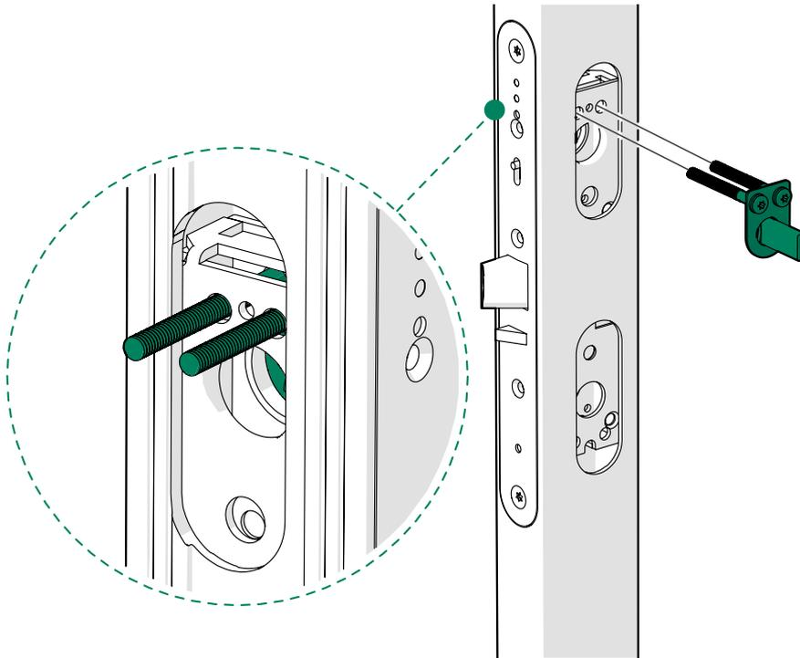
9. De l'extérieur, assemblez la serrure connectée et la poignée de porte avec la tige sur la porte et serrez les 2 vis de l'intérieur.
