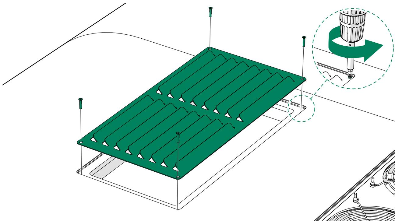
2. Dévissez les vis maintenant le module de ventilation en place.
