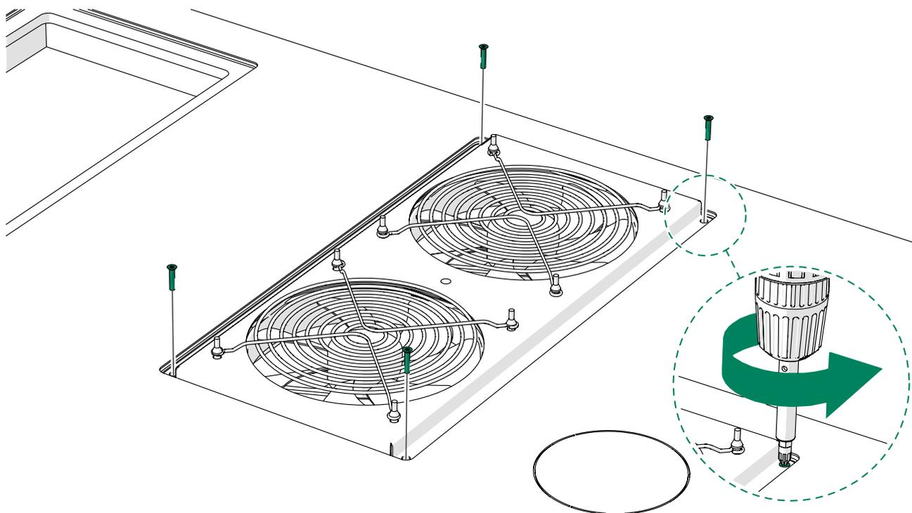
3. Soulevez le module de ventilation pour le dégager du module de toit et débranchez les connecteurs d'alimentation CC.
