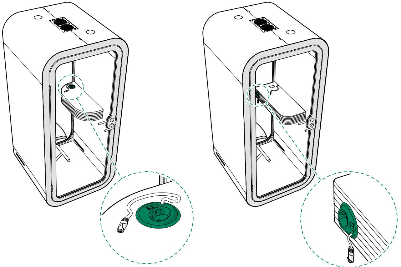
Figura 1: Toma de corriente en Framery O y Framery O con mesa ancha
