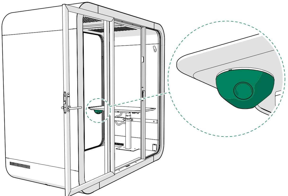
Figura 3: Toma de corriente en Framery Q Flow
