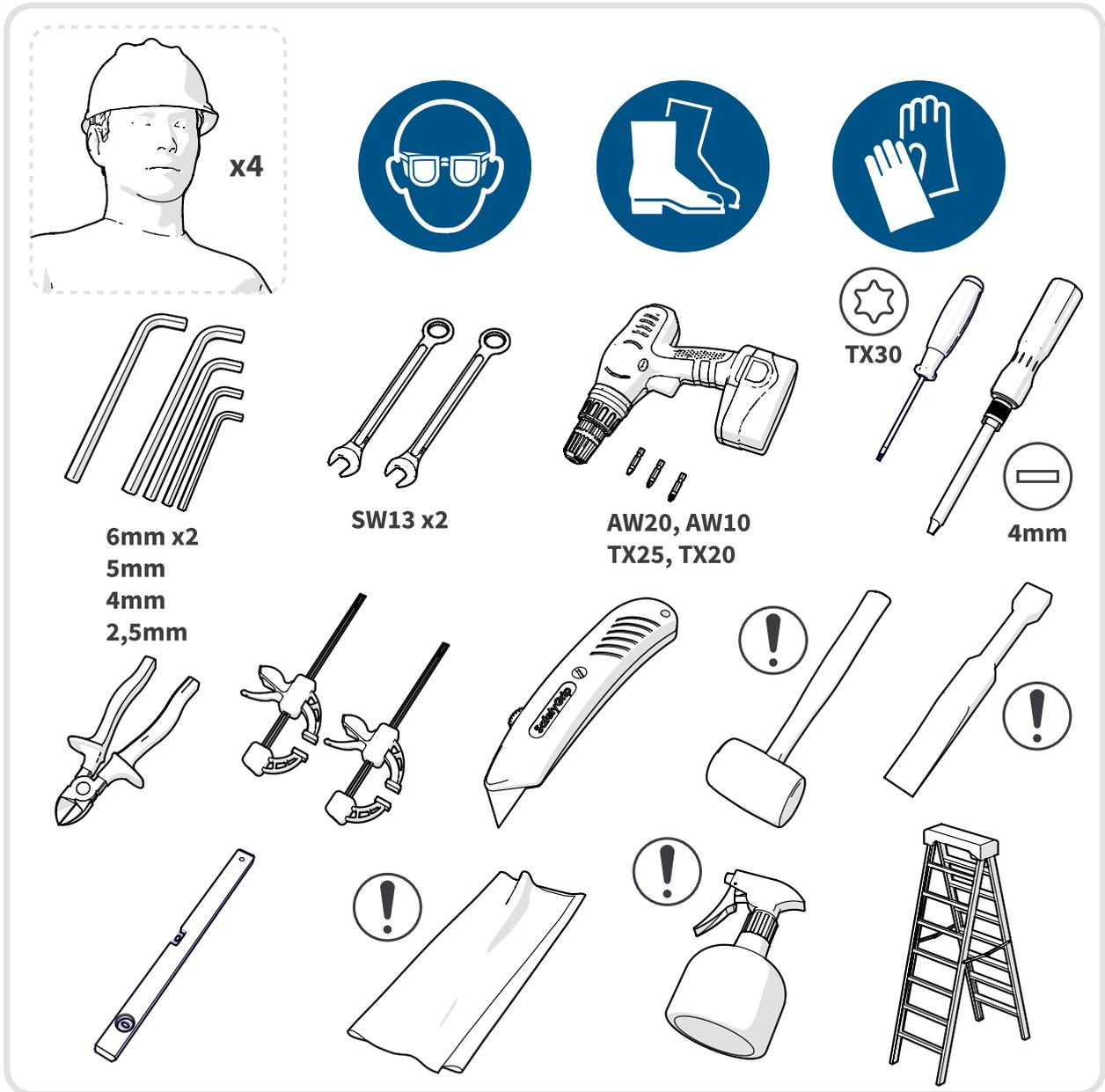
Figura 1: Herramientas y accesorios necesarios para la instalación
