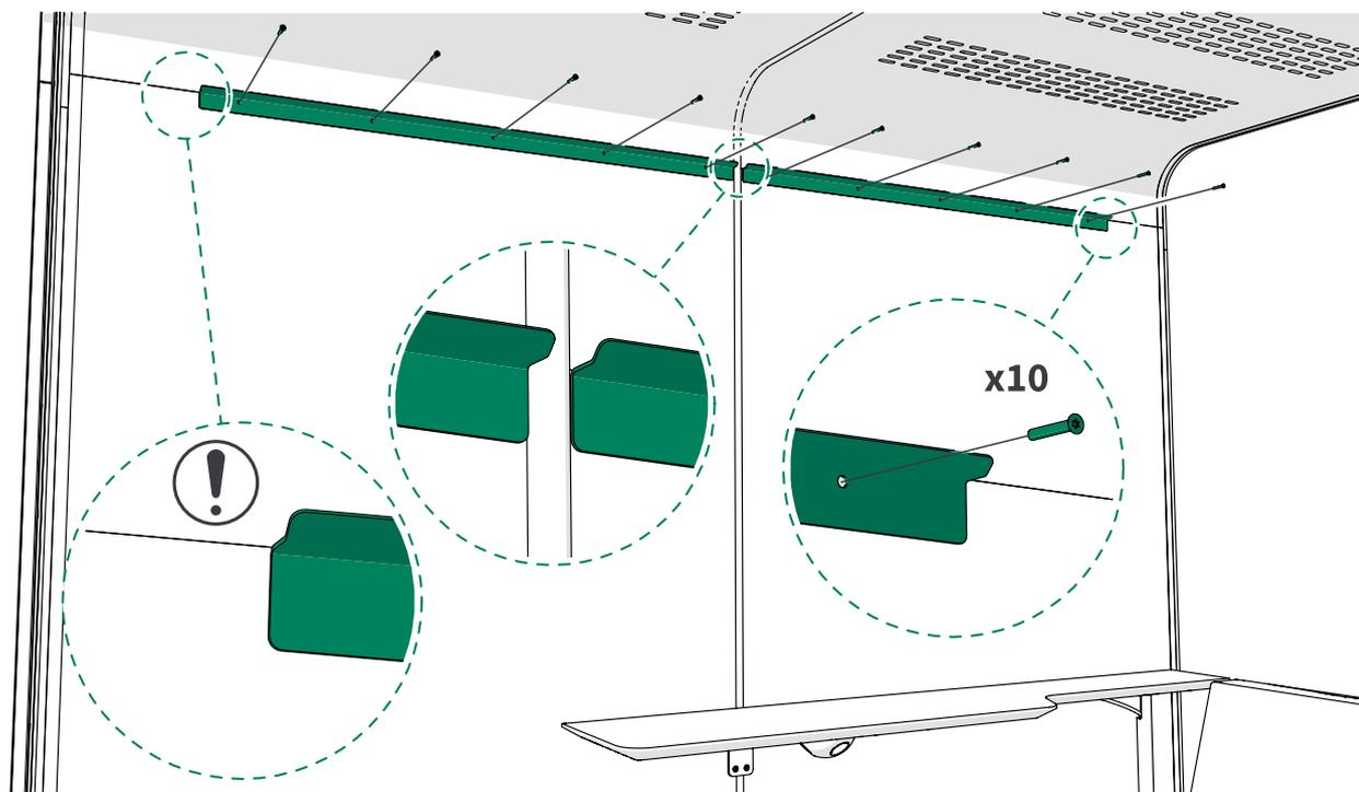
2. Instale los soportes de la pizarra blanca en la pared con tornillos 4x40 (10 unidades).
