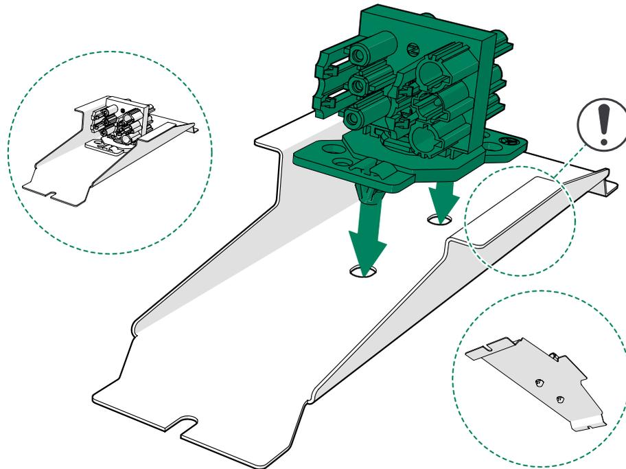
6. Presione el soporte de montaje en la placa de montaje de alimentación entre la unidad de alimentación y el convertor.
