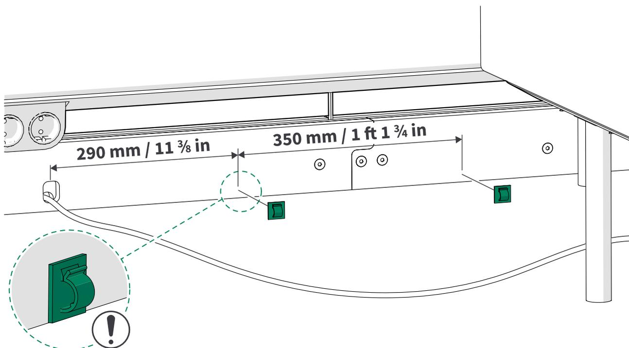
3. Guíe el cable de alimentación interno en los clips para cables.
