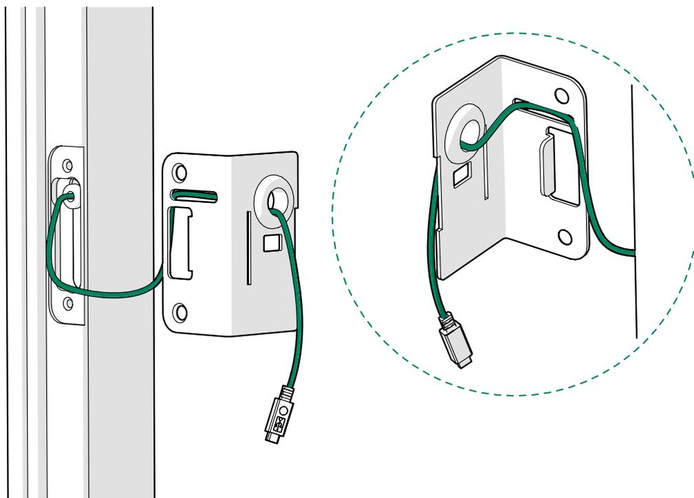
7. Monte el soporte para sistema de reservas con un tornillo M6x30 y una tuerca cilíndrica M6.
