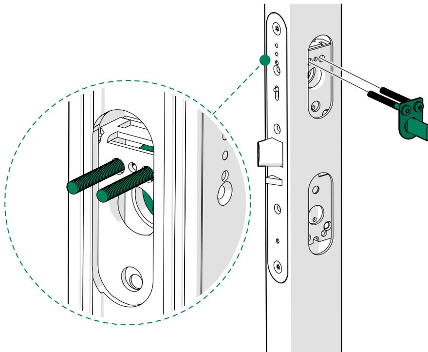
9. Instale el conjunto del cierre electrónico y la manilla de la puerta con el husillo sobre la puerta desde el exterior, y apriete los tornillos (2 unidades) desde el interior. Utilice un destornillador manual para apretar los tornillos. No apriete demasiado. Si el pestillo de la cerradura no vuelve fácilmente a la posición inicial, afloje ligeramente los tornillos y compruebe de nuevo el funcionamiento de la cerradura.
