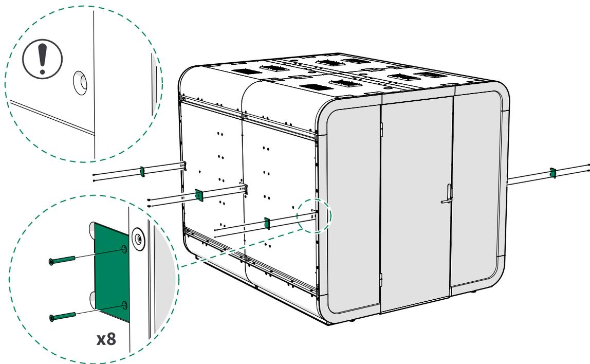
2. Vuelva a instalar los paneles de la cubierta grandes (8 unidades) en las paredes con tornillos 4x30 (64 unidades).
