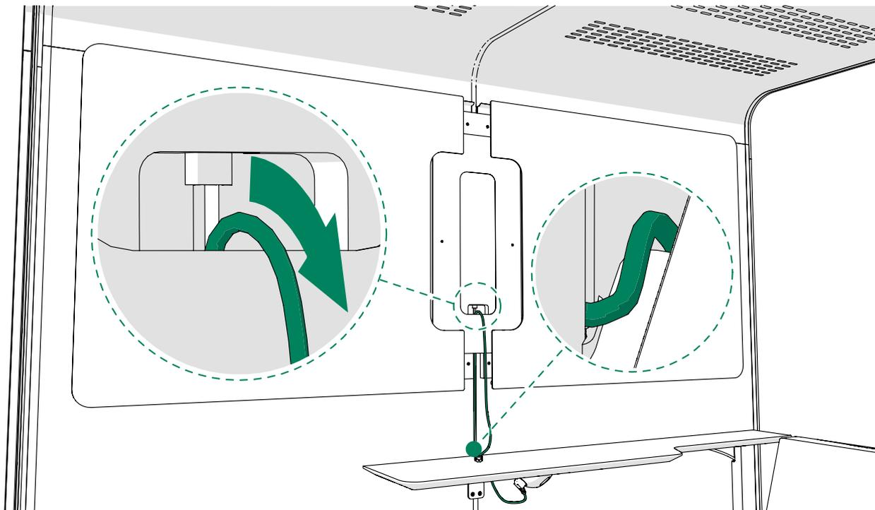
10. Si dispone de un cable HDMI suministrado por el cliente, guíe un extremo a través del perfil en U hasta el soporte de monitor y fuera de su abertura, y el otro extremo desde el perfil en U hasta la mesa.
