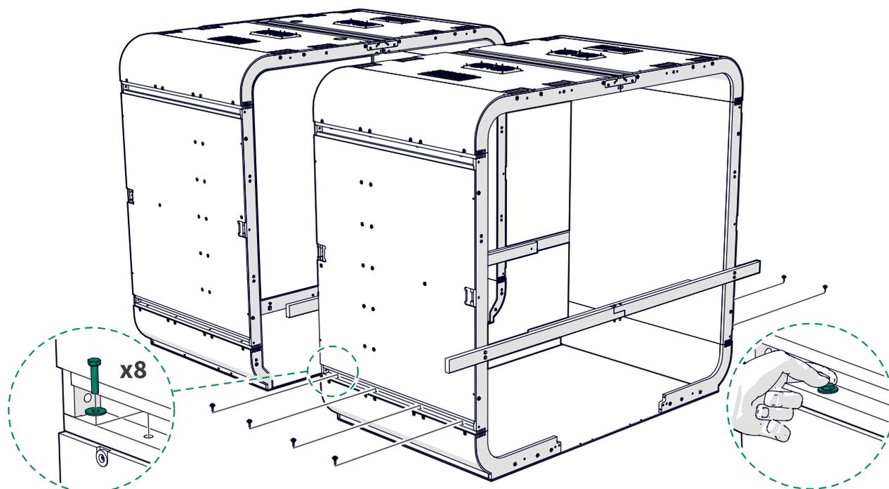
3. Retire la viga de soporte interior y guárdela para su uso posterior.
