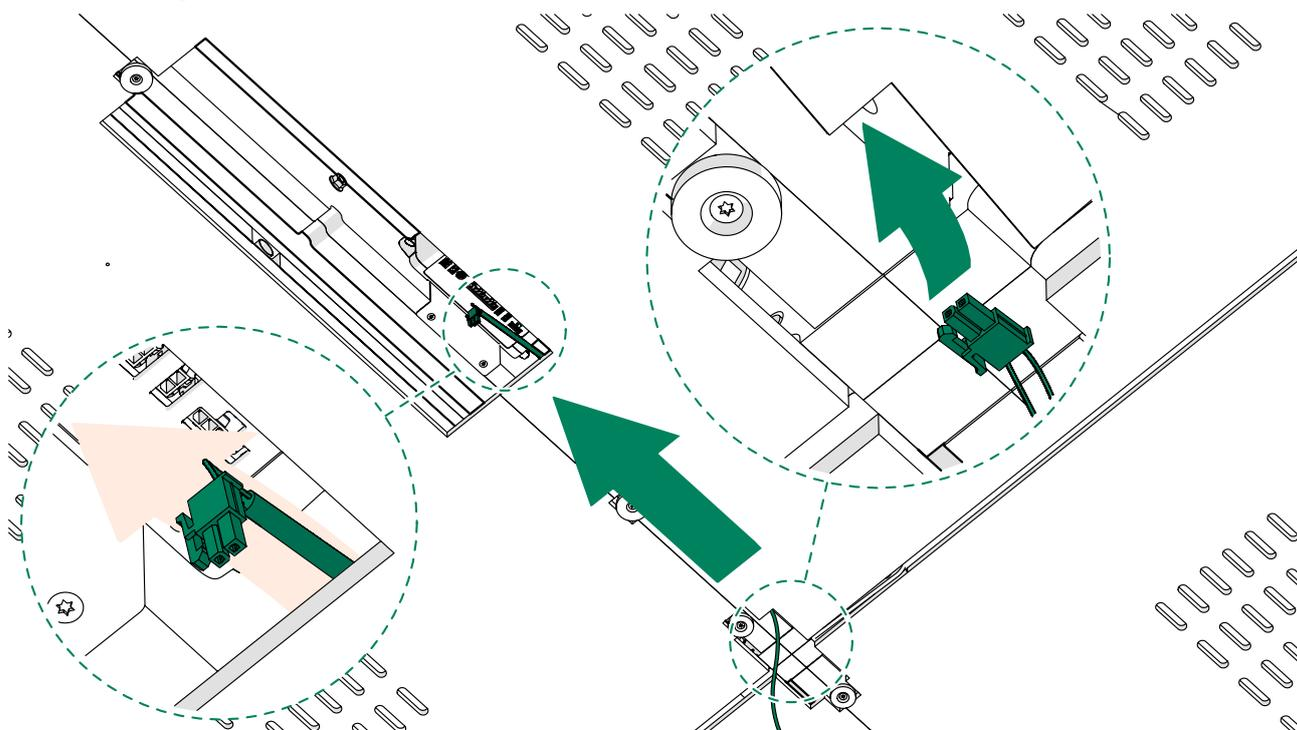
5. Conecte el alargador CC al conector PWR IN de la unidad de control.
