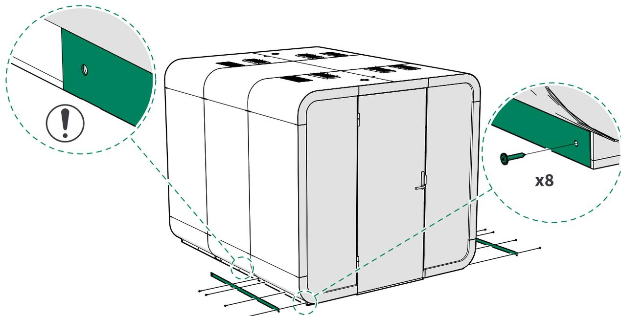
2. Instale la placa de la cubierta negra en cada lado de la mitad trasera del suelo de la cabina con tornillos negros wronic 4,2x25 (5 unidades).
