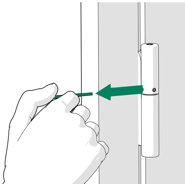
11. Ajuste la bisagra inferior con el mismo ajuste que la bisagra superior.
