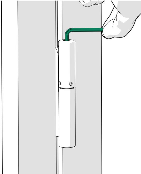
2. Apriete el resorte en el sentido de las agujas del reloj con una llave hexagonal de 5 mm hasta el punto en que sienta resistencia.
