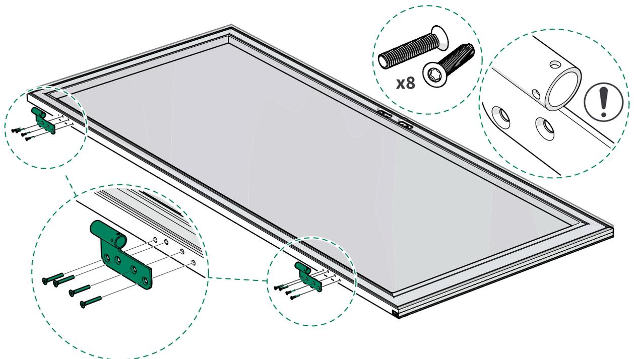
4. Fije las mitades inferiores de las bisagras al marco de la puerta con tornillos Taptite negros M6x30 (4 unidades cada uno) e instale una placa de ajuste de 1 mm en el agujero de montaje de la bisagra inferior. Utilice una herramienta manual para apretar los tornillos.
