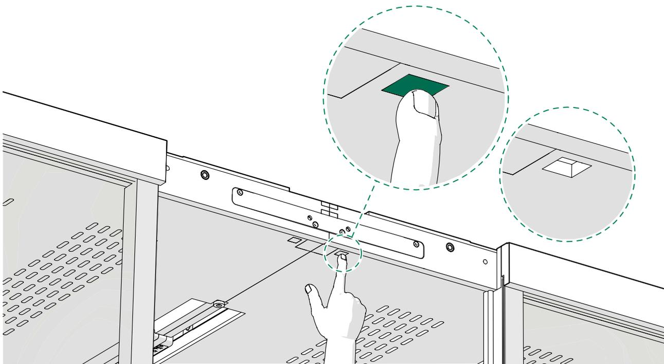
2. Guíe los cables USB y del panel de control desde el perfil en U del marco del cristal del lado del cerradero a la unidad de control y sáquelo de la abertura delantera del techo.
