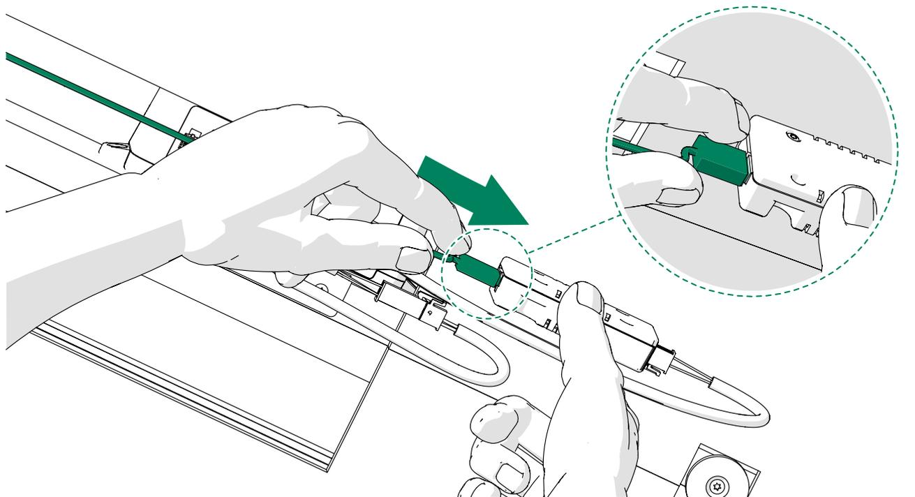
7. Conecte la unidad de 5V al conector PWR IN de la unidad de control.
