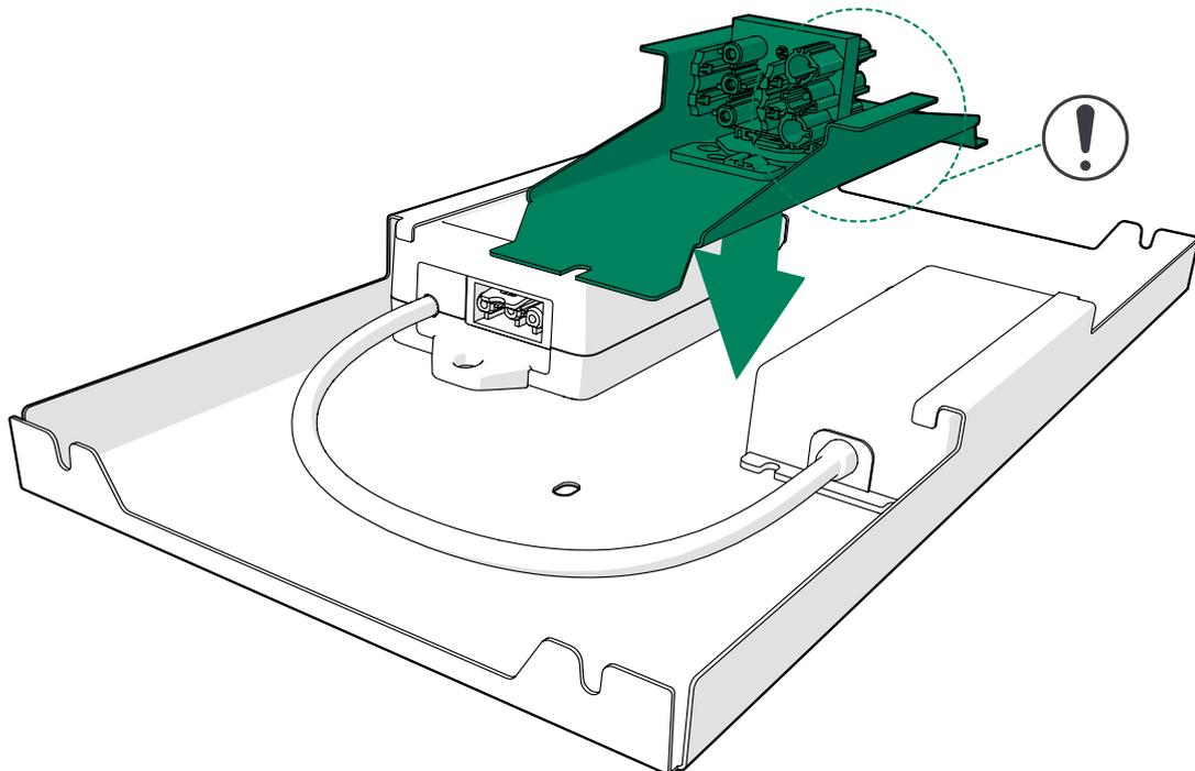
7. Coloque la placa de montaje de alimentación aproximadamente en el centro del hueco en el lado derecho de la parte inferior del sofá trasero e instálela en la parte inferior del sofá con tornillos 3x12 (2 unidades).
