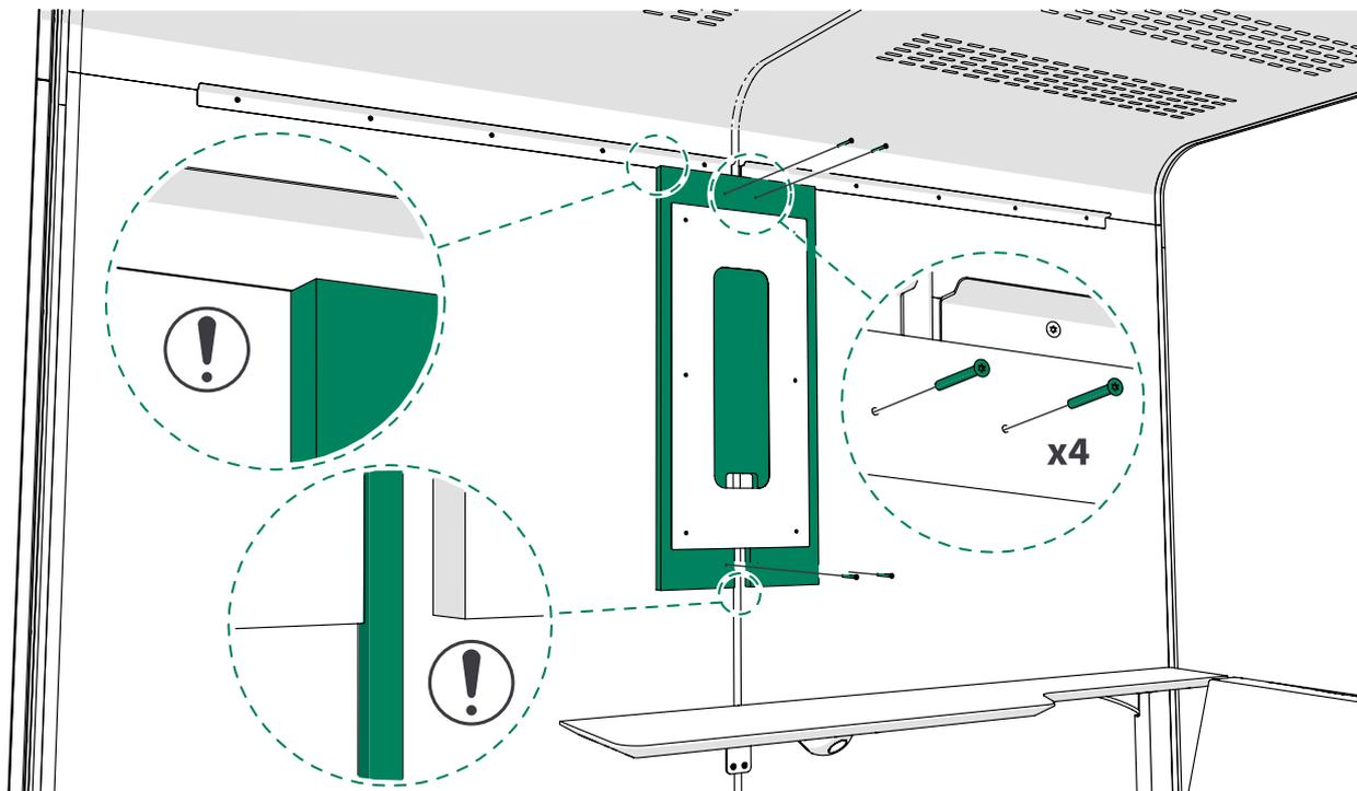
4. Instale los imanes (2 unidades) debajo de la contraplaca de madera. Mida 45 mm desde la goma del perfil en U hasta el orificio del tornillo en el imán y realice la instalación con tornillos 4x40 (2 unidades).
