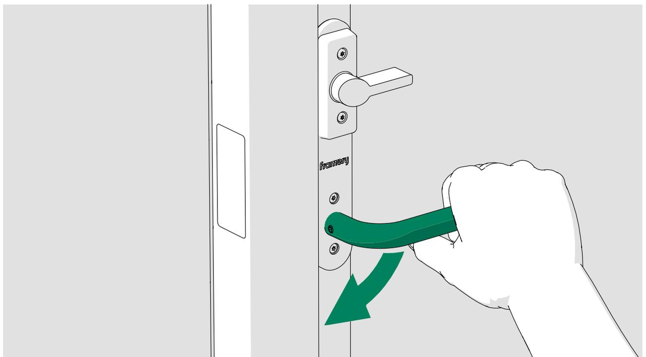
6. Presione la manilla de la puerta y la palanca giratoria hacia abajo. La puerta debería abrirse.
