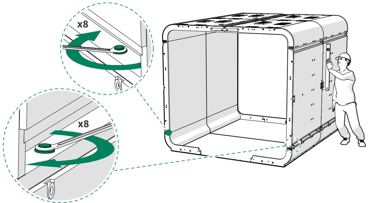
9. Apriete los pernos (8 unidades por lado) en la unión del techo y del módulo de pared de las mitades trasera y delantera de la cabina.
