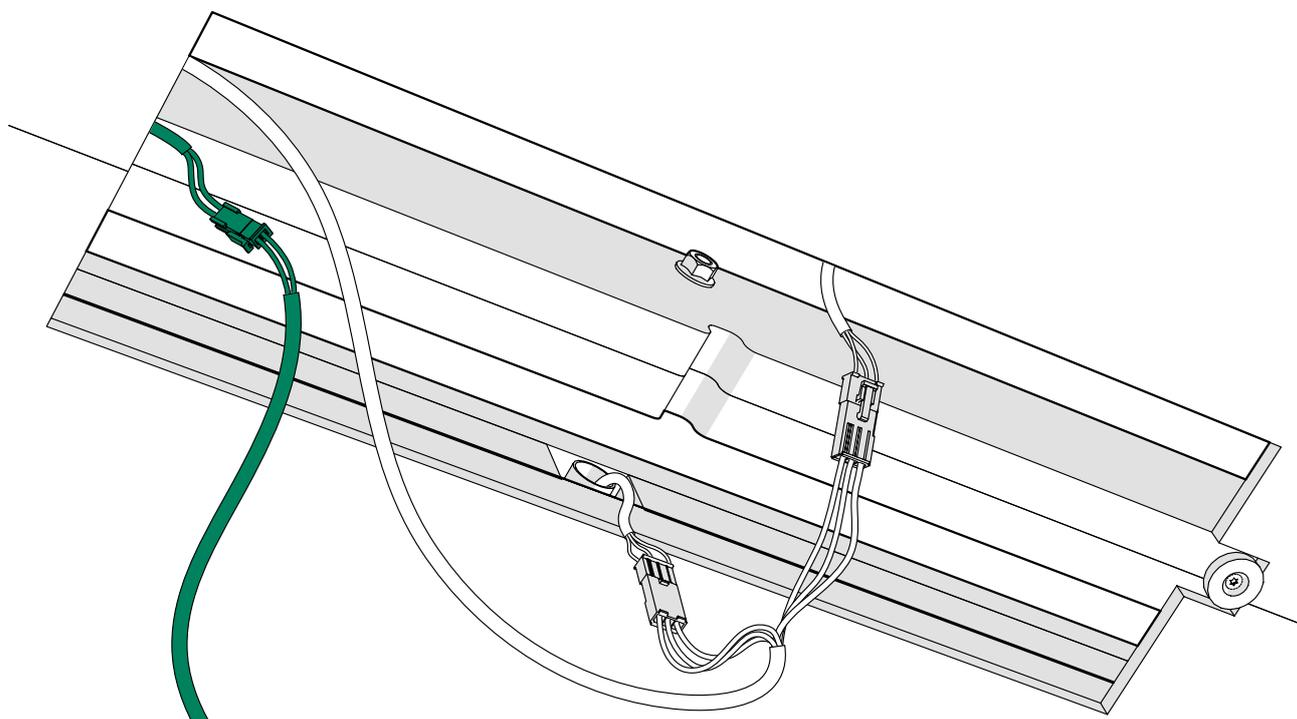
2. Instale los cables de las luces en el techo con tornillos 4x20.
