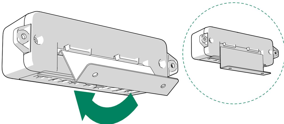
3. Instale el soporte con la unidad de control en la abertura delantera del techo con tornillos 3x12 mm (2 unidades).
