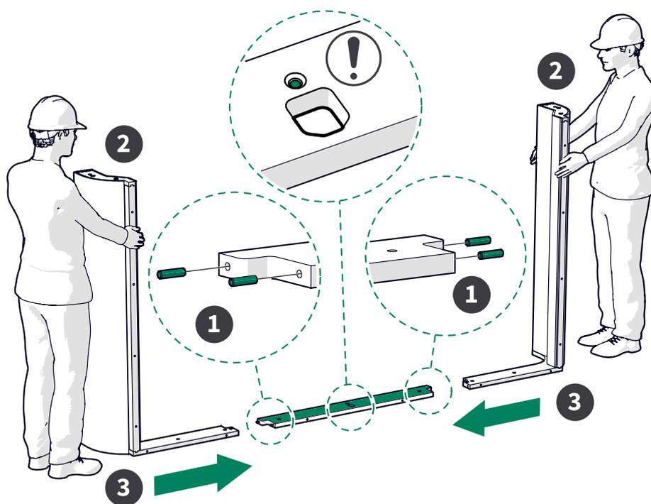
4. Presione las clavijas de madera (14 unidades) en las cantoneras y en la viga en I.
