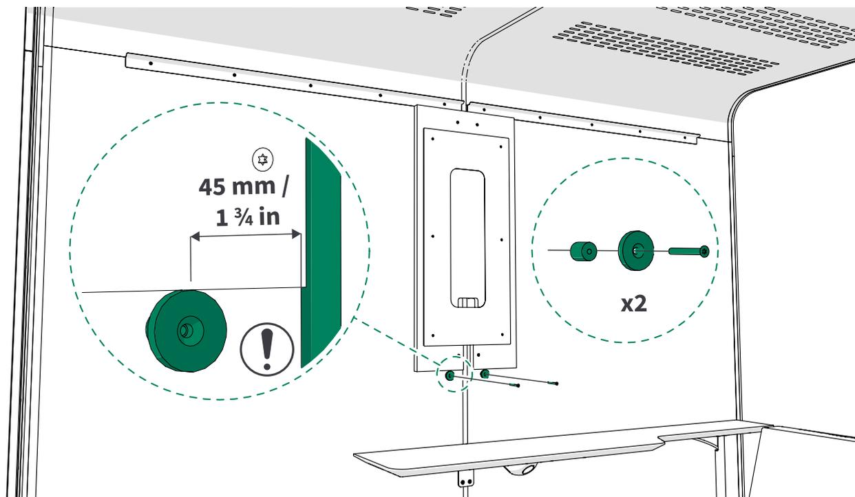
5. Instale imanes (2 unidades) para los bordes exteriores de las pizarras blancas. Mida 1150 mm desde la goma del perfil en U hasta el orificio del tornillo en el imán y realice la instalación con tornillos 4x40 (2 unidades).
