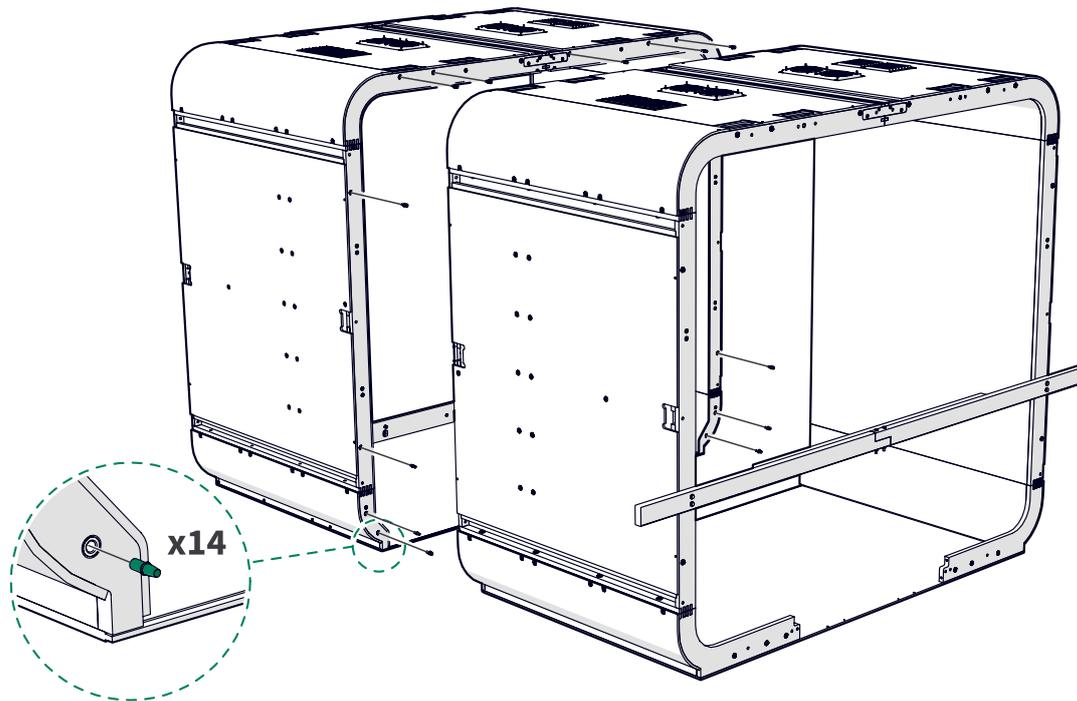
2. Instale el perfil metálico en forma de "H" en la ranura del tablero de suelo de la mitad trasera de la cabina.
