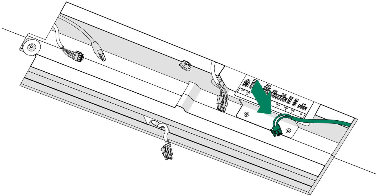
4. Conecte el cable del separador CC en la unidad de 5V.
