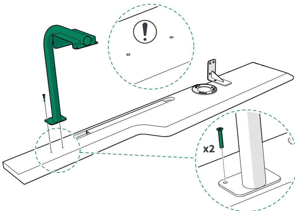
3. Instalación de la toma de corriente en el soporte debajo de la mesa.
