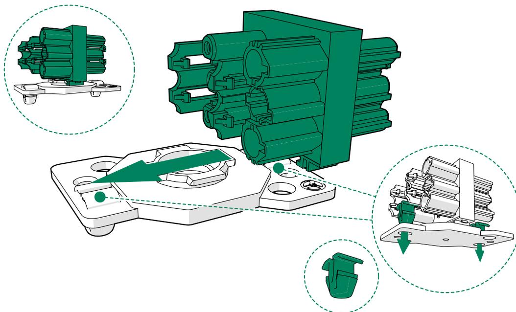
5. Instale la placa de instalación en el soporte de montaje mediante los espárragos de plástico.
