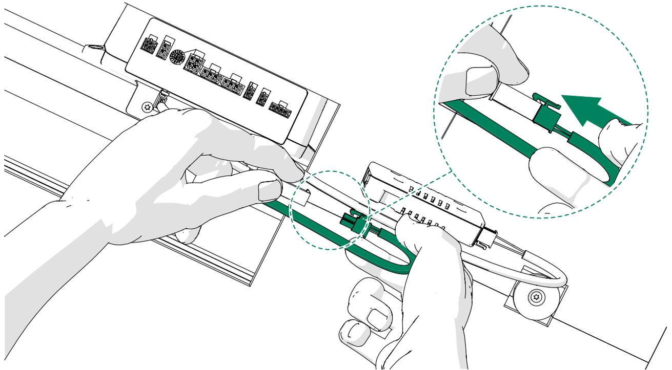
6. Conecte el cable USB al conector USB de la unidad de 5V.
