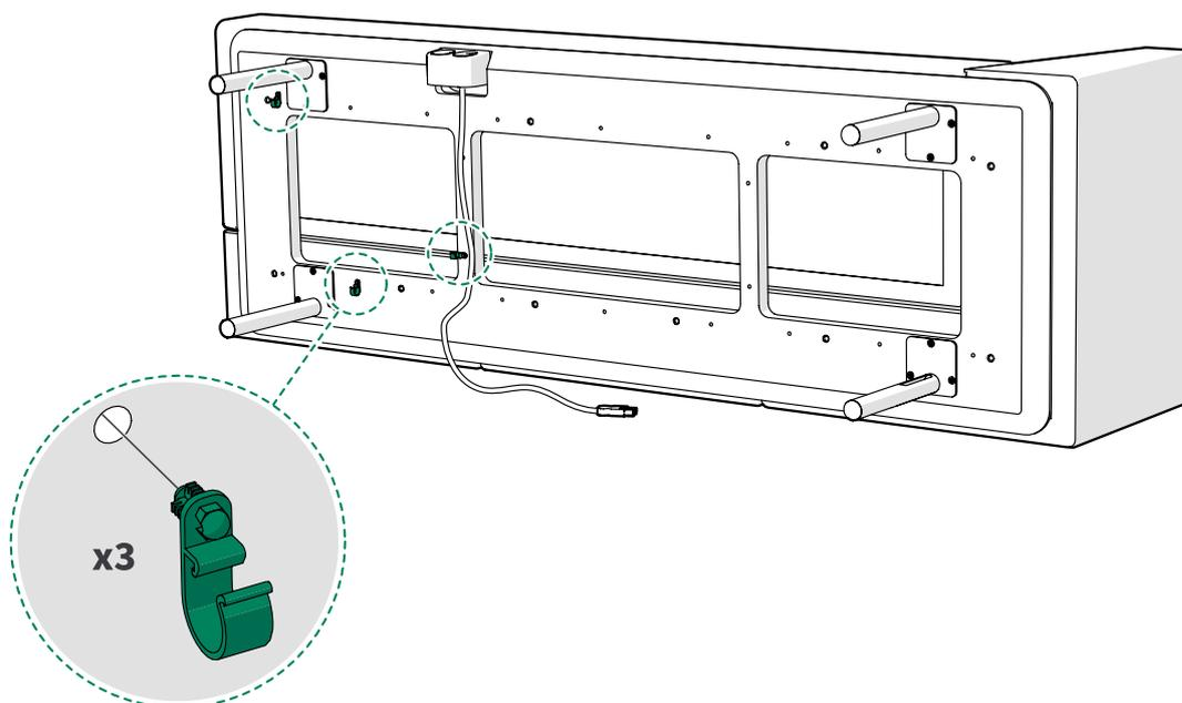
8. Guíe el cable de la toma de corriente a través de dos soportes de cables.
