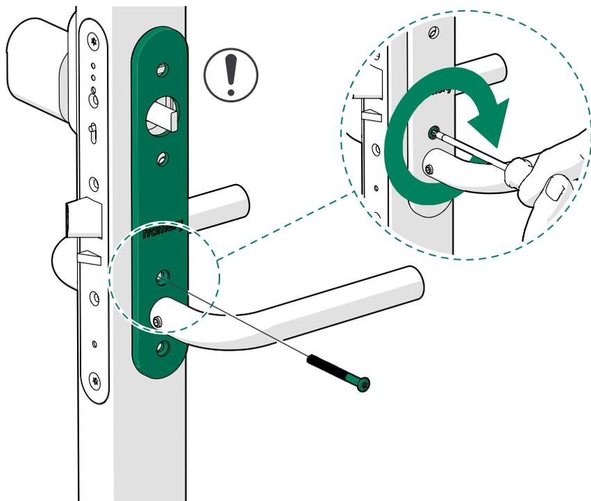
12. Instale la palanca giratoria con los tornillos M5x61 previamente cortados (2 unidades), y la placa de la manilla con el tornillo M5x32 restante desde el interior.
