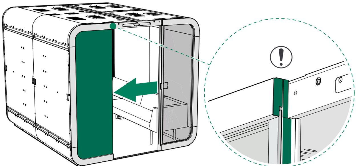
5. Compruebe la desviación de la cabina ligeramente por debajo de la unión del techo y el módulo de pared con un nivel de burbuja.
