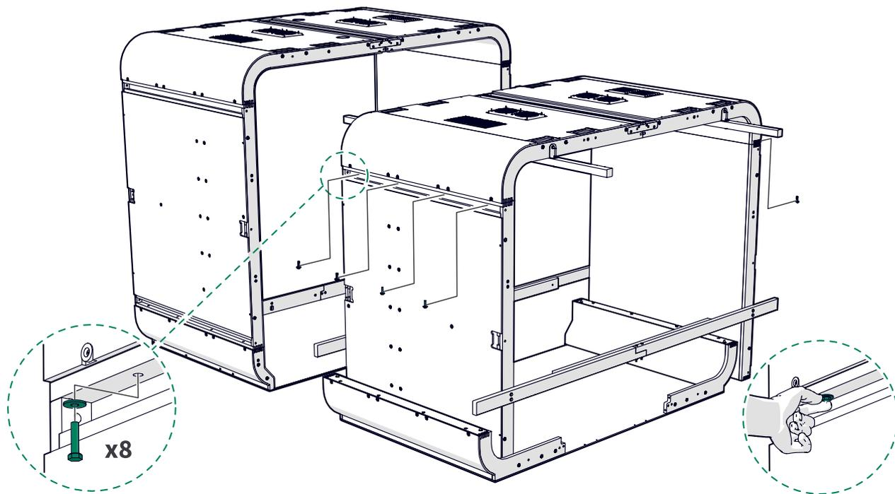
6. Retire las vigas de soporte del techo y guárdelas para su uso posterior.
