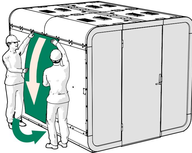
3. Instale las chapas exteriores de la pared (2 unidades en cada lado) en los bordes de la pared de la cabina.
