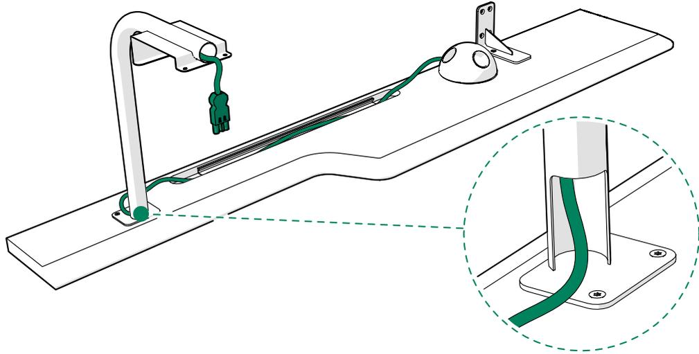
6. Presione la cubierta del conducto en su posición.
