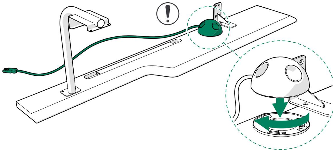
4. Retire la cubierta del conducto de cables.
