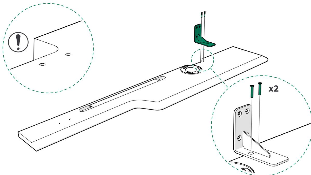
2. Instale la pata de apoyo de la mesa en la mesa con tornillos negros 5x30 (2 unidades).
