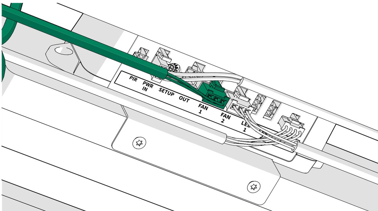
6. Conecte el alargador de la luz al conector LED 2 de la unidad de control.
