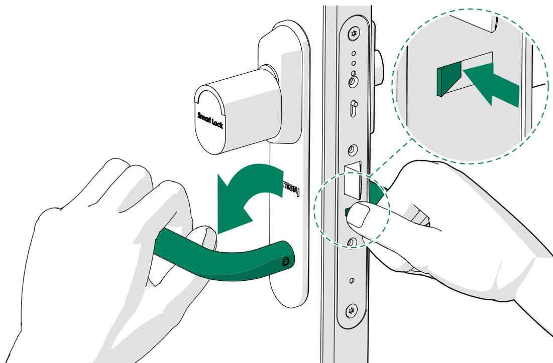
4. Con el pestillo más pequeño presionado, presione la palanca giratoria hacia abajo para probar el funcionamiento del pestillo de la cerradura.
