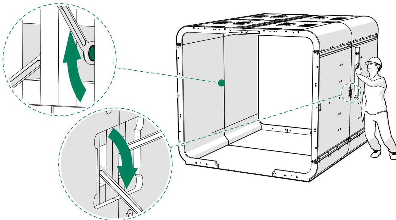
5. Apriete los pernos (2 unidades) que conectan las mitades trasera y delantera de la cabina en la unión del techo y del módulo de pared.
