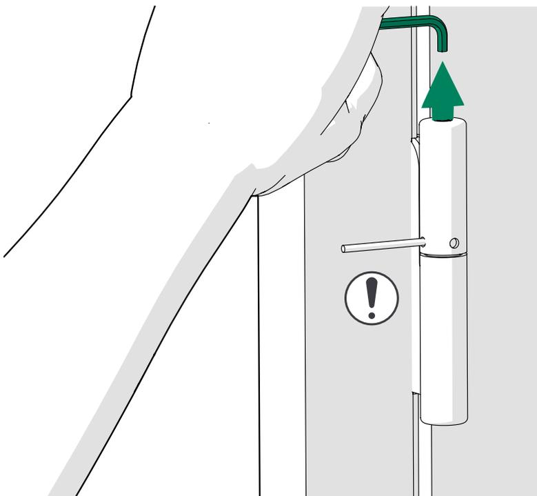
5. Vuelva a introducir la llave hexagonal de 5 mm en la parte superior de la bisagra.
