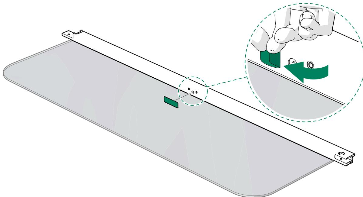
3. Instale el soporte del panel de control en el marco del cristal del lado del cerradero con tornillos M4x10 (2 unidades).
