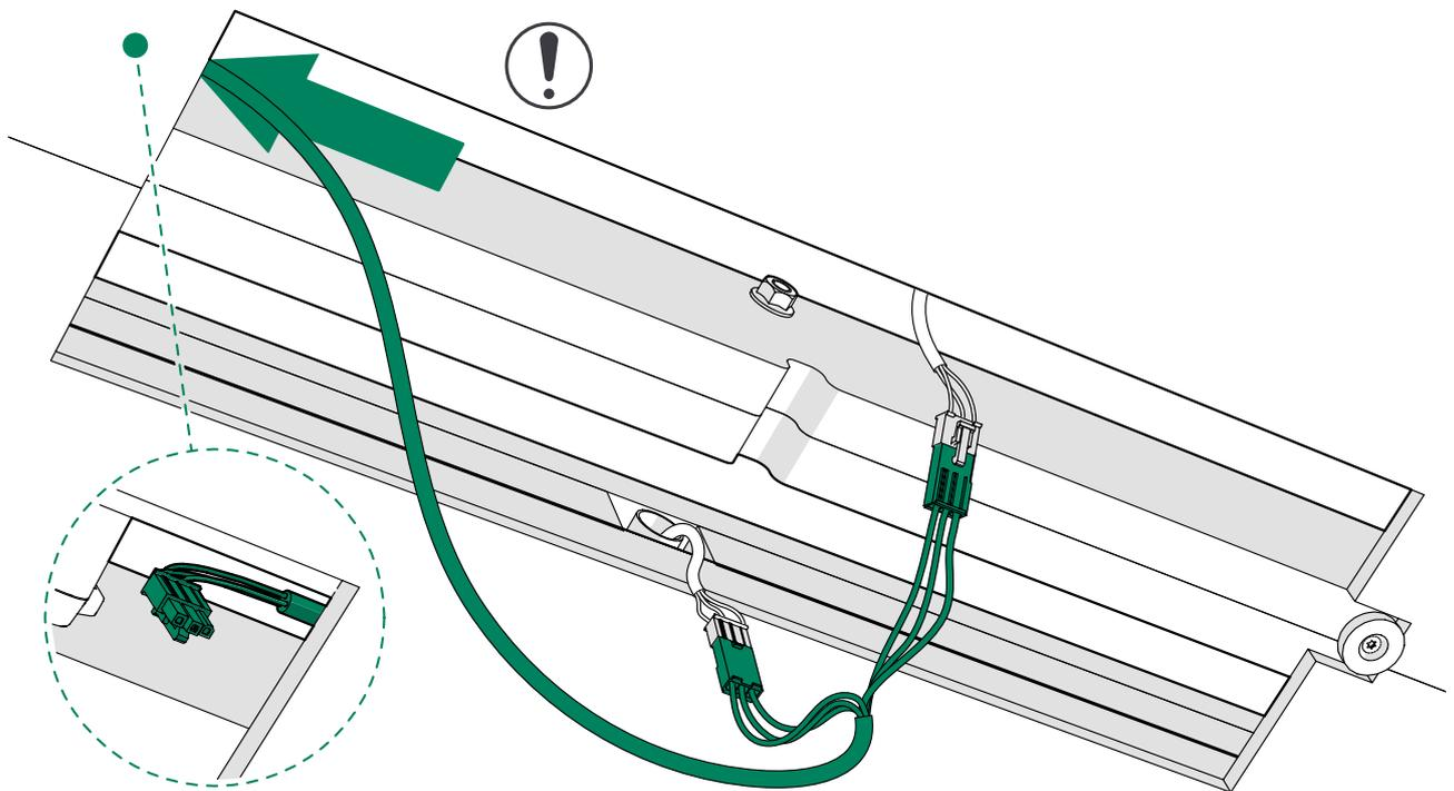
3. Conecte el alargador largo del ventilador en el conector FAN 2 de la unidad de control.
