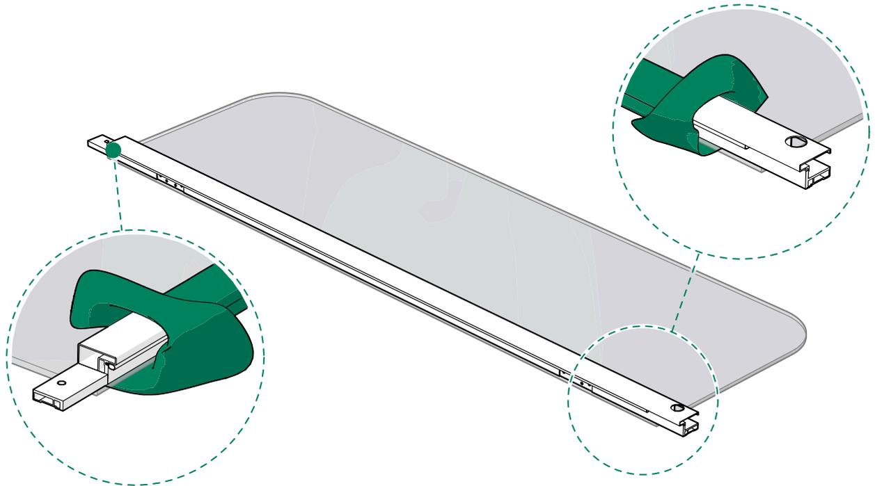
4. Guíe el cristal del lado de la bisagra dentro de las ranuras y deslícelo en su posición.
