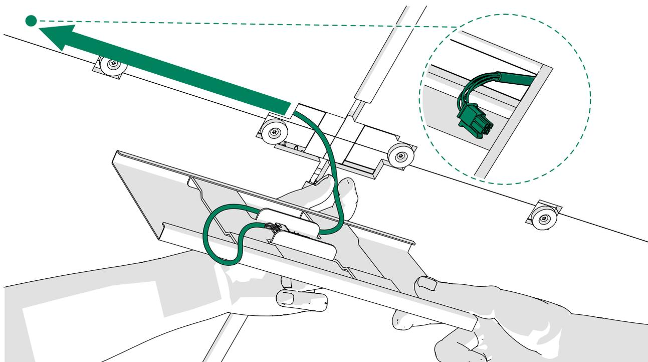
2. Conecte el cable CC del sensor de movimiento al conector PIR de la unidad de control.
