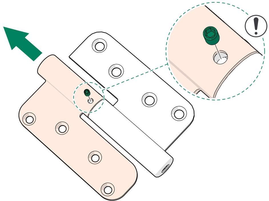
3. Fije las mitades superiores de las bisagras a la puerta con tornillos Taptite negros M6x30 (4 unidades cada uno). Utilice una herramienta manual para apretar los tornillos.
