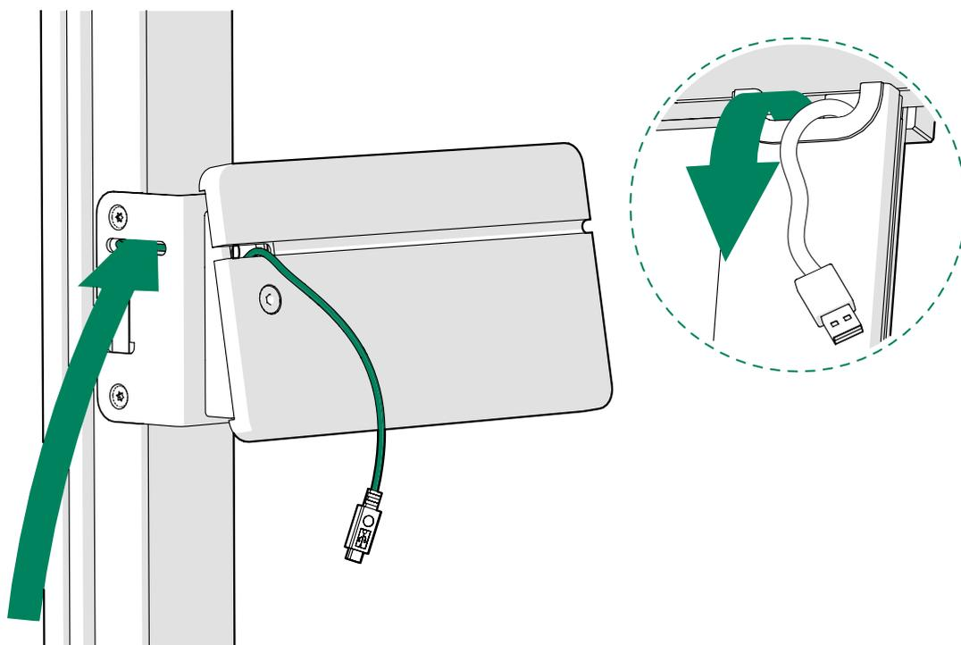
11. Instale la cubierta de plástico en la ranura del cerradero.
