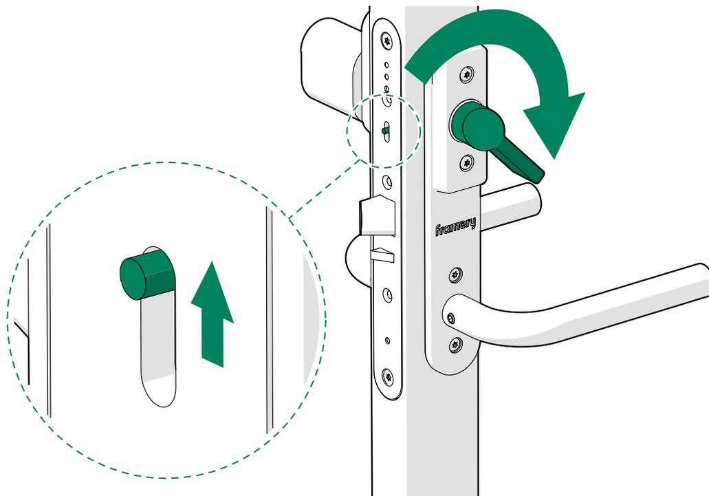
2. Presione la manilla de la puerta hacia abajo para comprobar el funcionamiento del pestillo de la cerradura.
