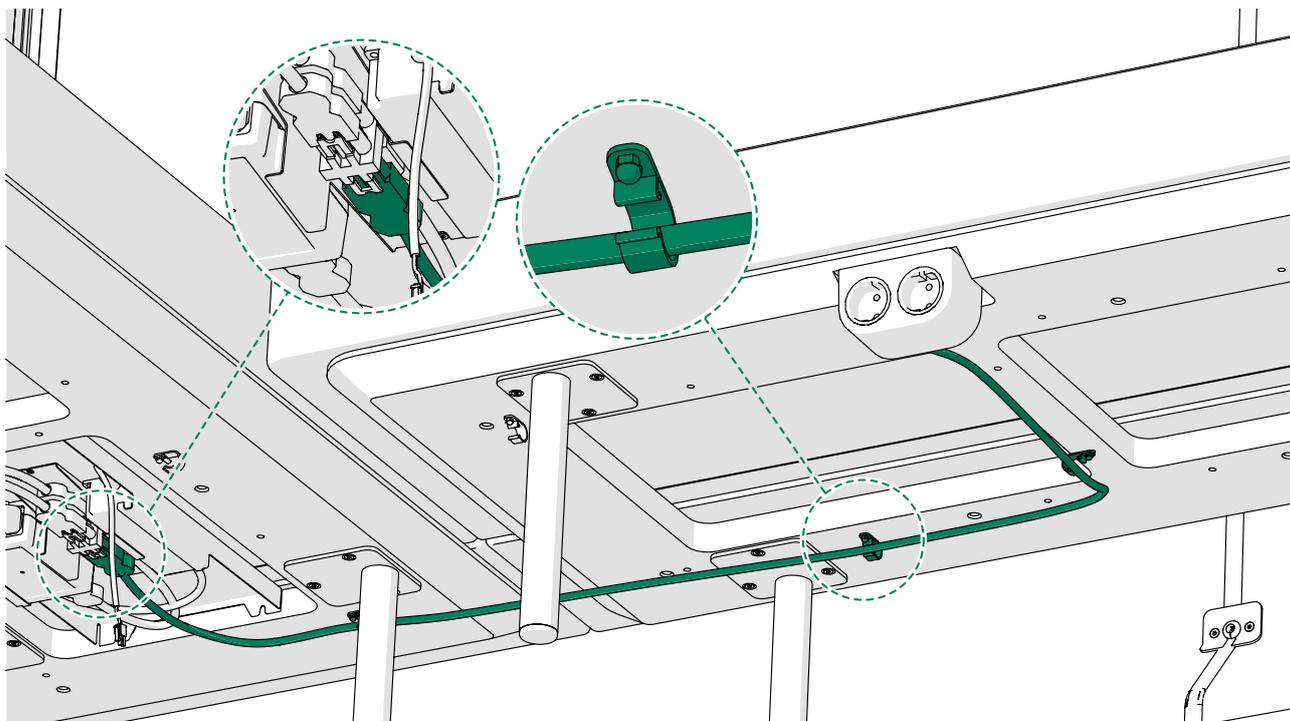
11. Conecte el alargador CC del módulo de suelo al convertor CC.
