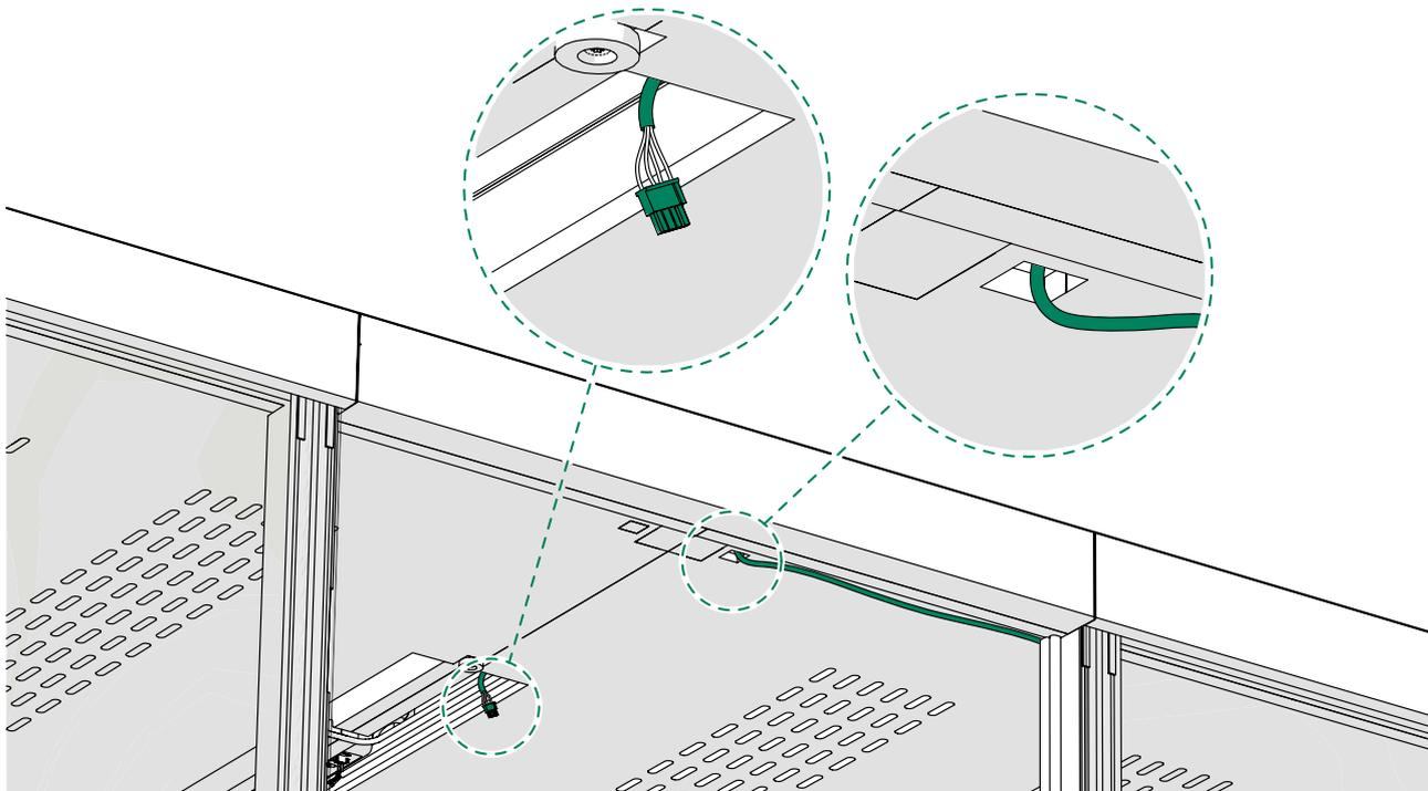
3. Conecte el cable del panel de control al conector UI de la unidad de control.
