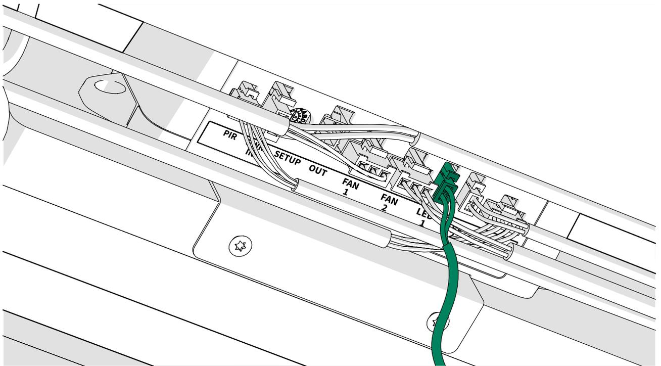
5. Instale los cables de las luces en el techo con tornillos 4x20.
