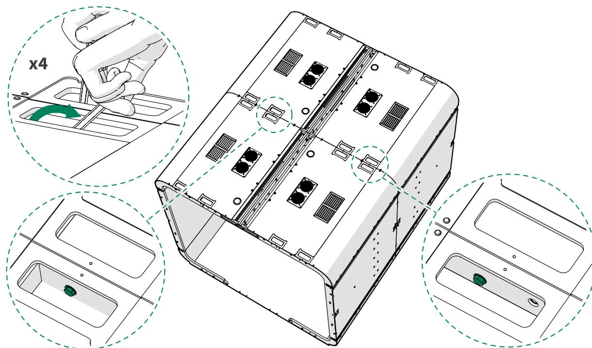
8. Apriete los pernos (8 unidades por lado) en la unión del suelo y del módulo de pared de las mitades trasera y delantera de la cabina.
