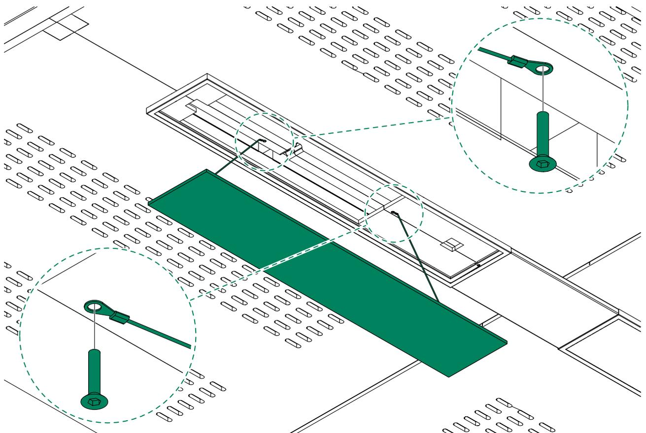
6. Instale la luz en el techo delantero, borde con borde con el sensor de movimiento. La luz se fija al techo con imanes.
