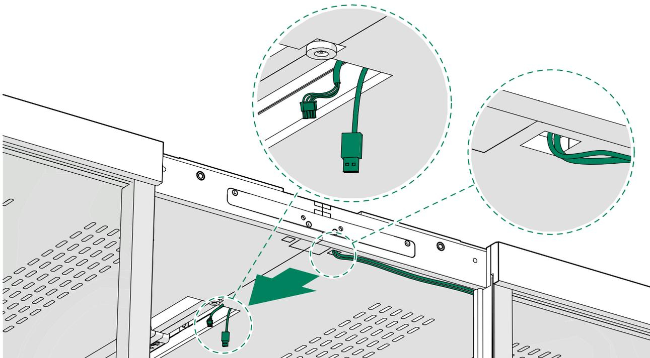
3. Desconecte el alargador CC del conector PWR IN de la unidad de control.
