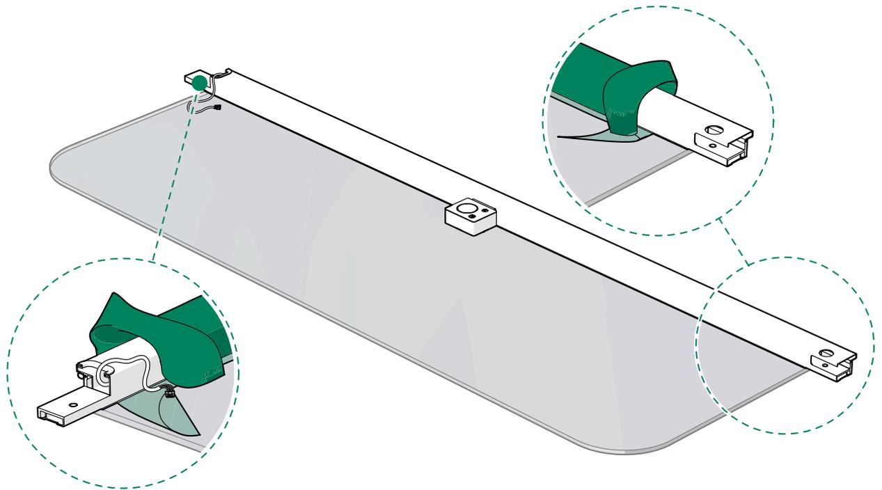
2. Guíe el cable USB suministrado por el cliente a través del orificio situado detrás del cerradero y sáquelo por el perfil en U situado en el borde superior del marco del cristal del lado del cerradero.
