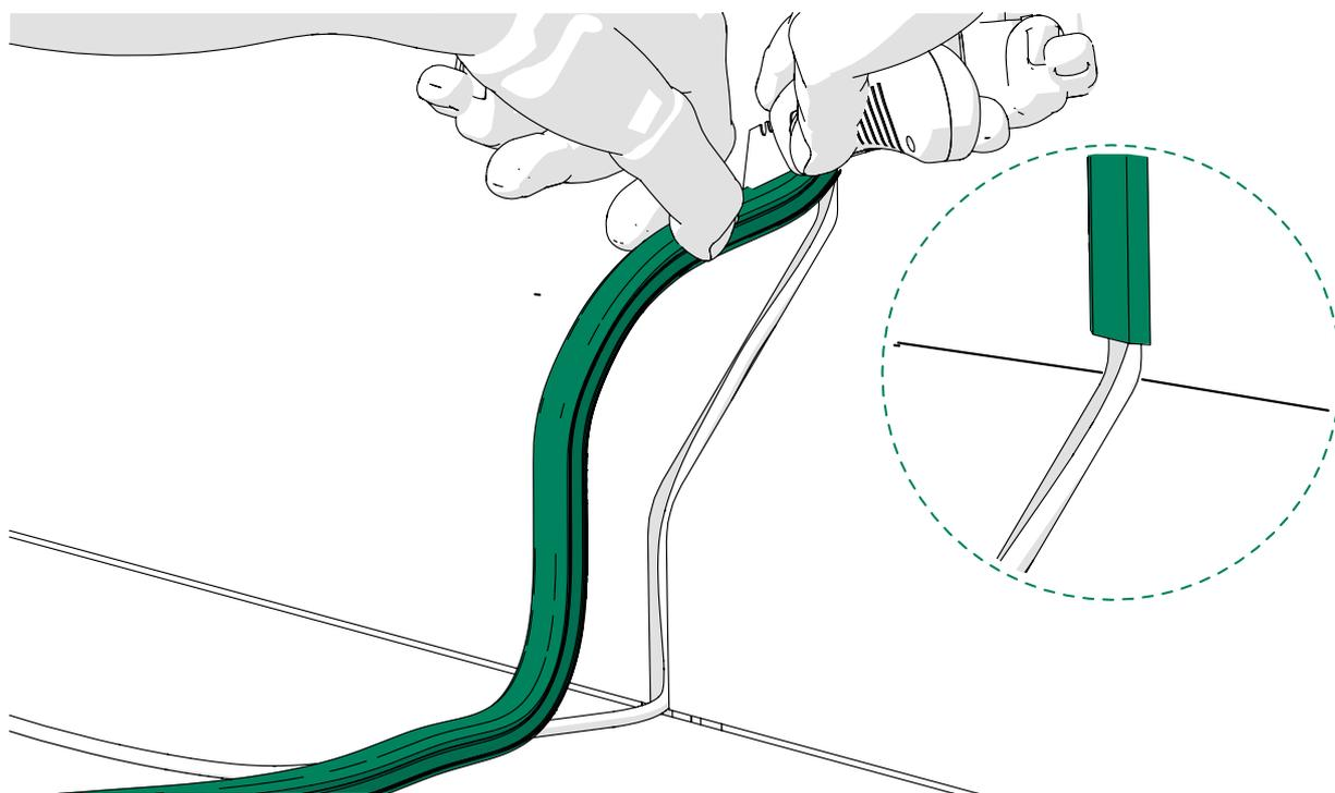
4. Instale el extremo recién cortado de la goma ligeramente por debajo del extremo cortado y deje el alargador CC fuera.
