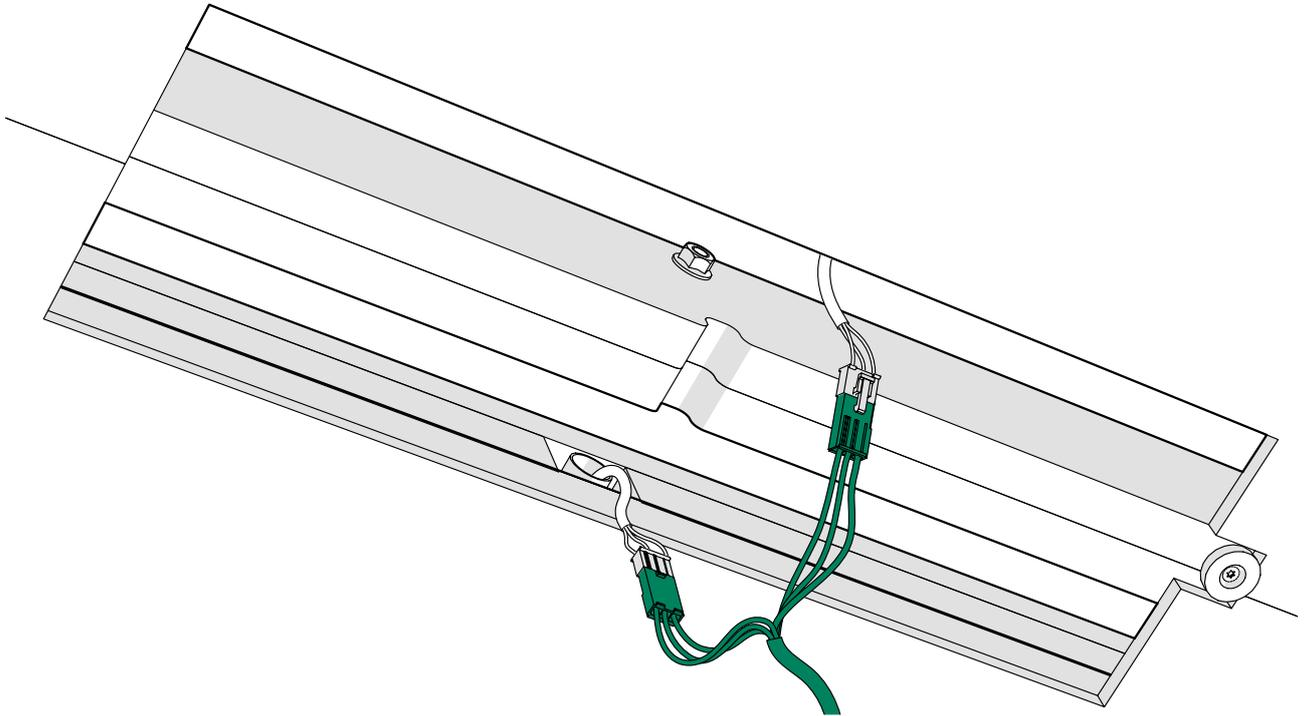
2. Pase el alargador largo del ventilador desde la parte trasera de la cabina a través de la ranura de la viga central y dentro de la cabina desde la abertura de la luz en la parte delantera.
