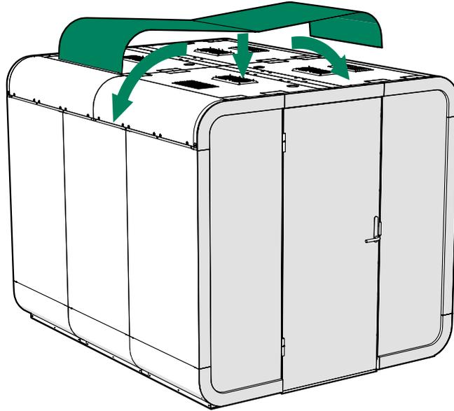
2. Instale las chapas exteriores del techo (2 unidades) en las esquinas trasera izquierda y delantera derecha del techo.
