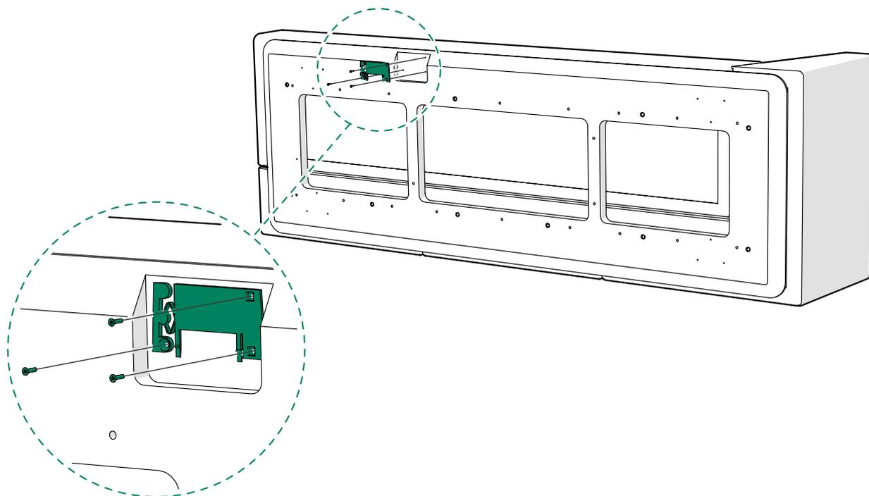
2. Deslice la toma de corriente sobre la placa de montaje.
