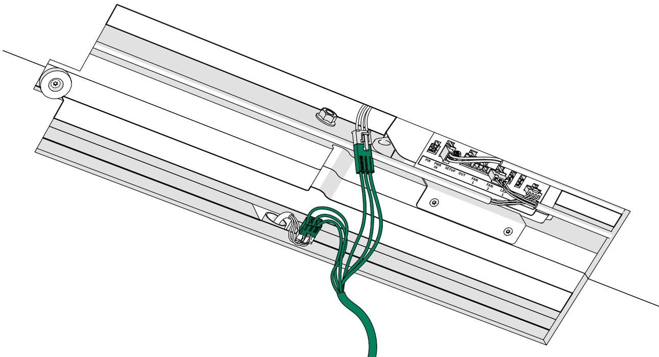
5. Conecte el alargador corto del ventilador al conector FAN 1 de la unidad de control.
