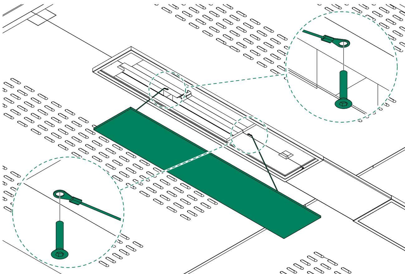
3. Instale la luz en el techo trasero, borde con borde con el sensor de movimiento. La luz se fija al techo con imanes.
