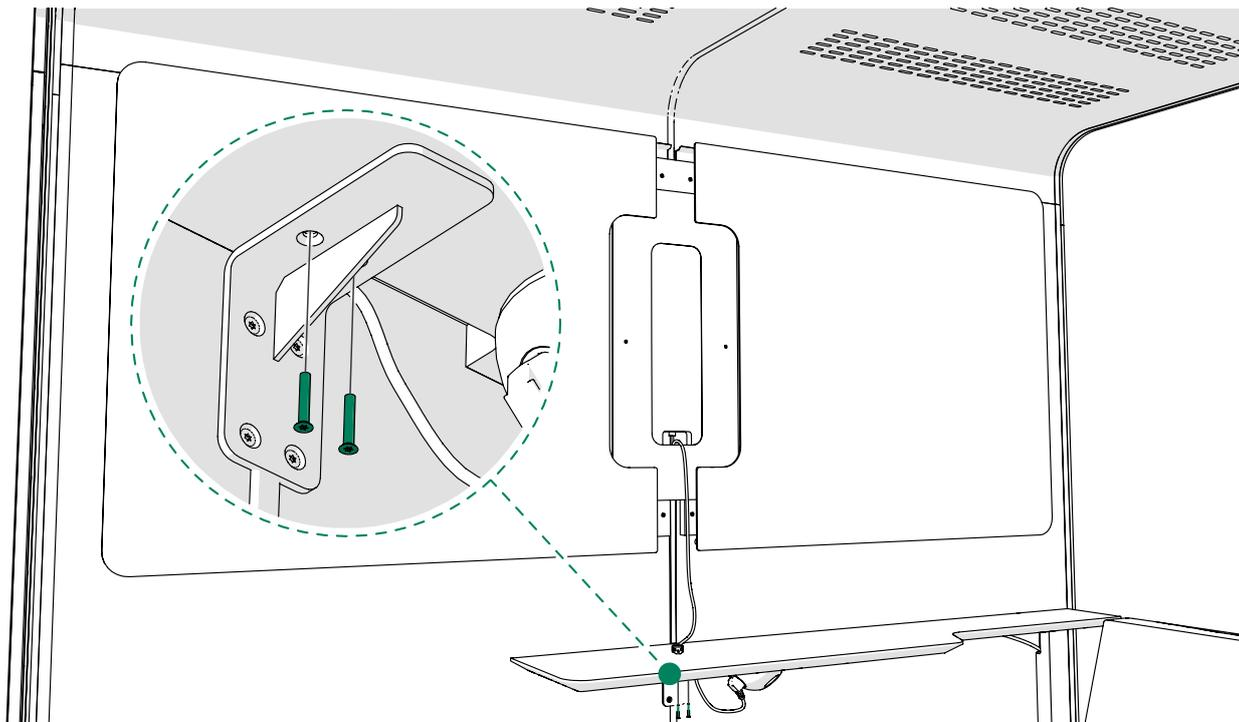
14. Instale el soporte de monitor en el centro de la contraplaca de madera.
