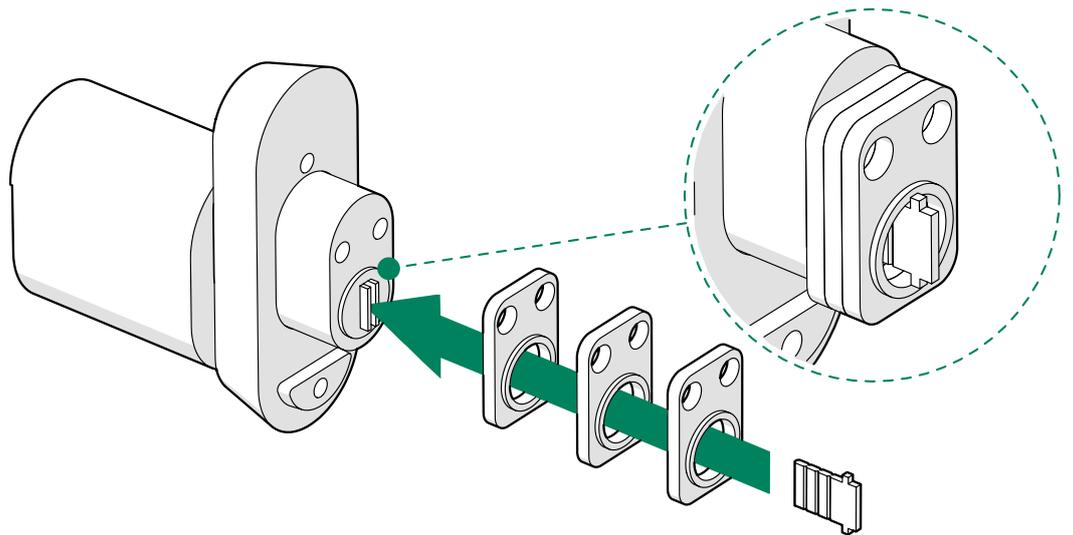
8. Coloque el conjunto de la placa del conector en la abertura superior de la puerta.
