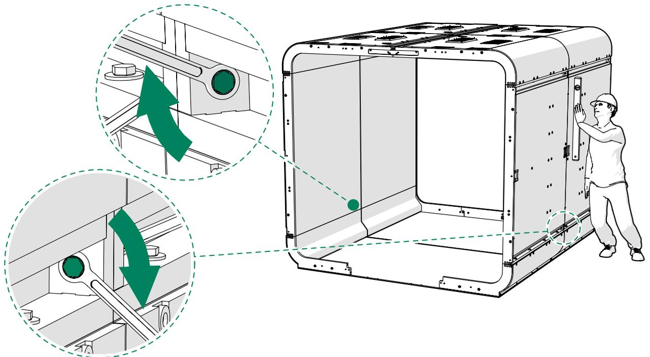
4. Apriete los pernos (2 unidades) que conectan las mitades trasera y delantera de la cabina en el centro del módulo de pared.
