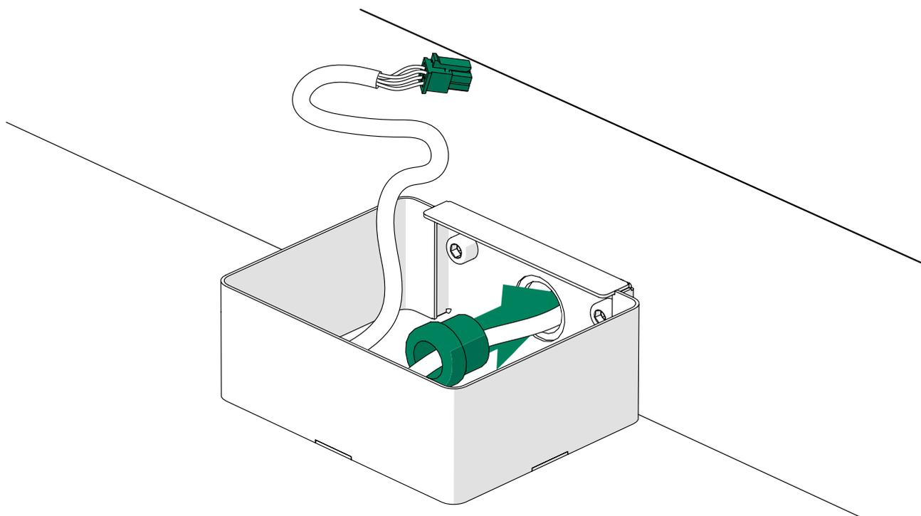
6. Instale los imanes (2 unidades) detrás del panel de control con tornillos M4x10 (2 unidades). Utilice una herramienta manual para apretar los tornillos.
