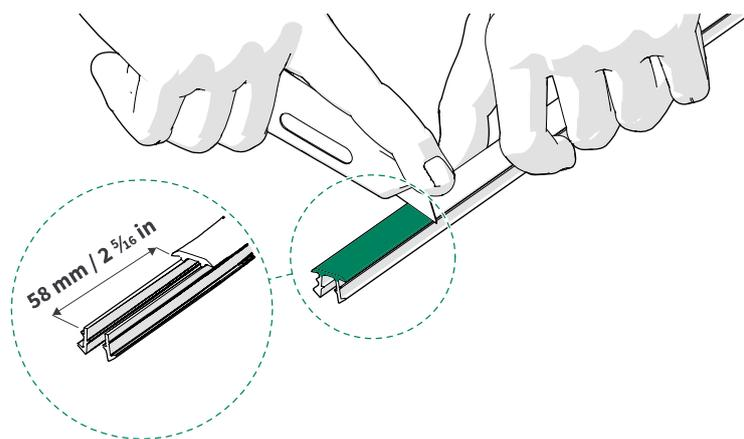
2. Corte la goma del perfil en U con el cable en el lado derecho de la cabina desde el techo hasta el centro del módulo de suelo.
