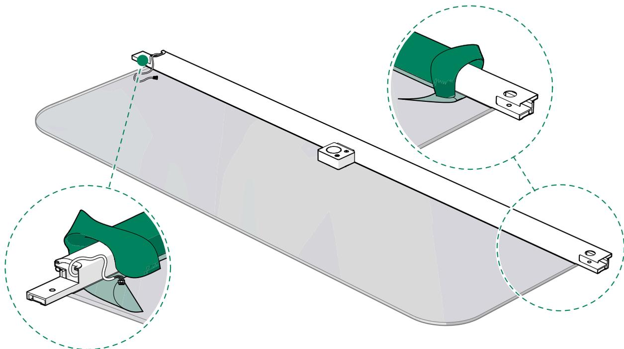
2. Guíe el cristal del lado del cerradero dentro de las ranuras y deslícelo en su posición.
