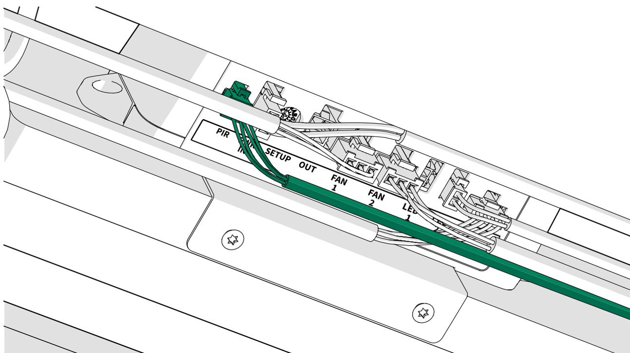
3. Eleve el sensor de movimiento hasta su posición para que encaje en los imanes.
