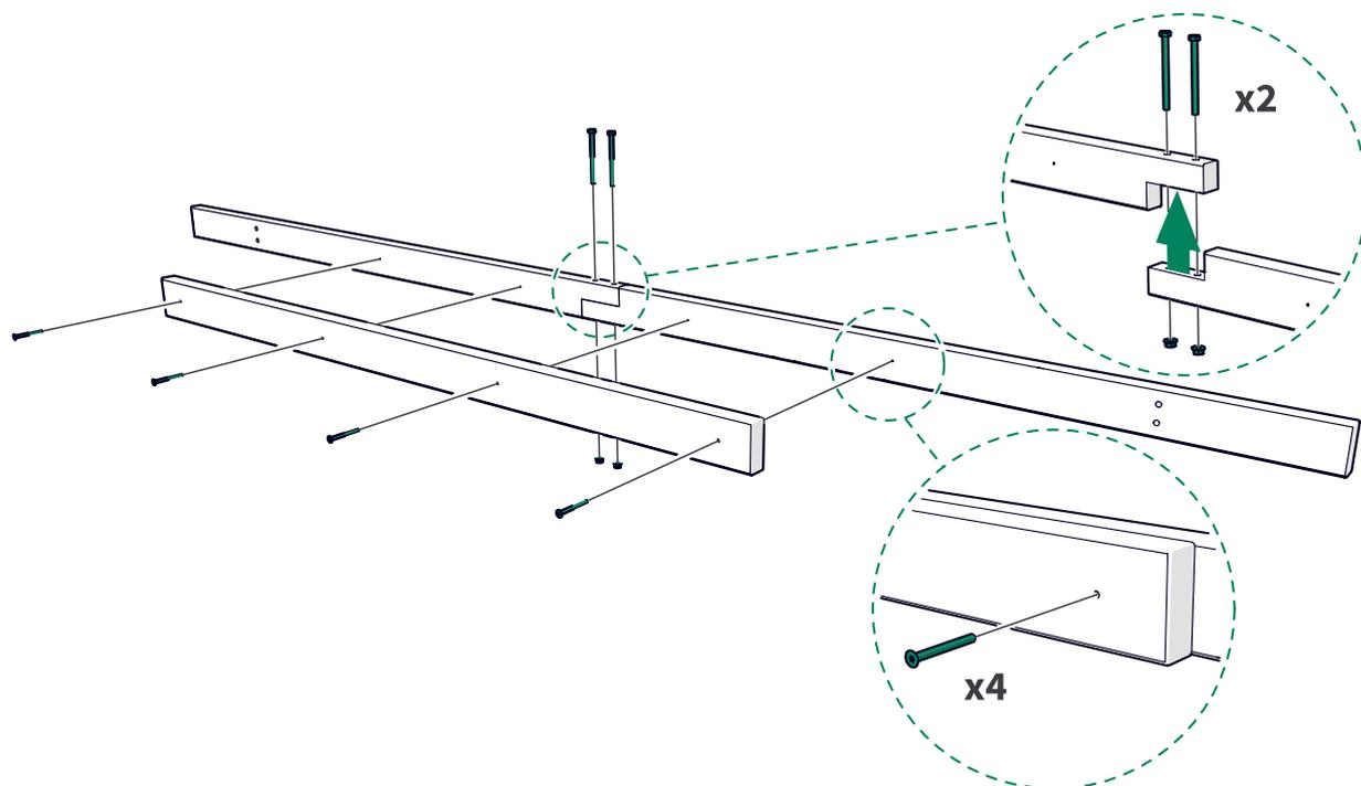
2. Desenrosque los tornillos 4x30 (20 unidades) y retire los paneles de la cubierta (8 unidades). Coloque los paneles de la cubierta y los tornillos a un lado.
