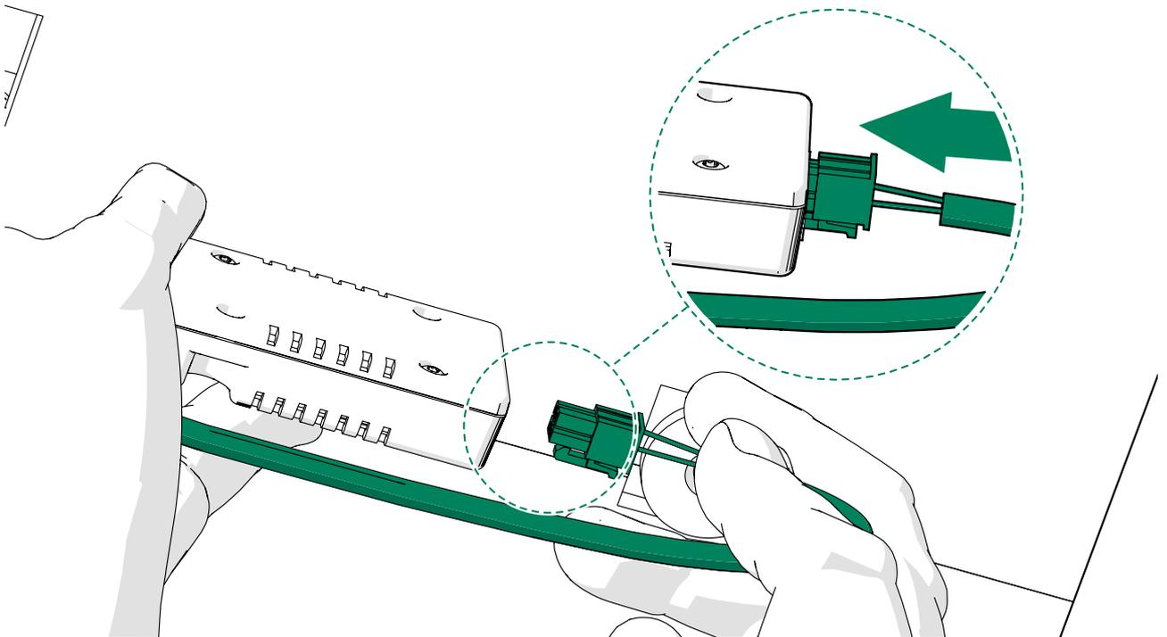
5. Conecte el alargador CC en el cable del separador CC.
