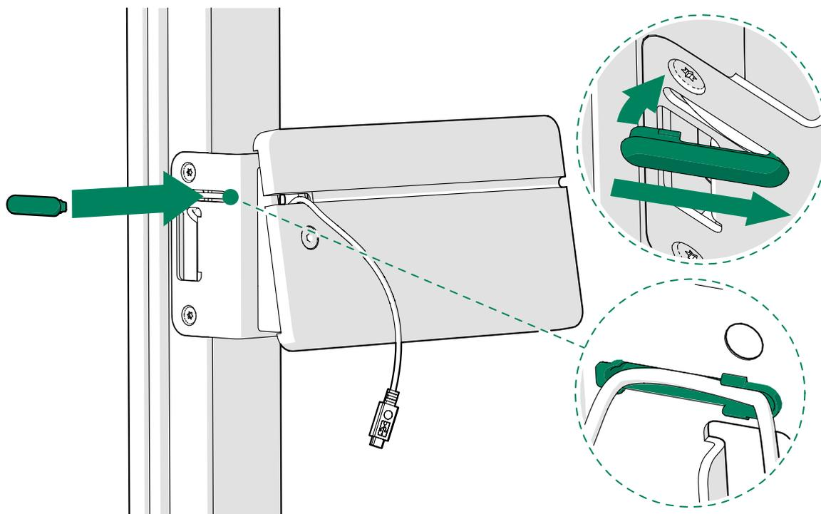
12. Instale el soporte de la tablet suministrada por el cliente en la placa de soporte para sistema de reservas con tornillos de 3,5x12 (2 unidades).
