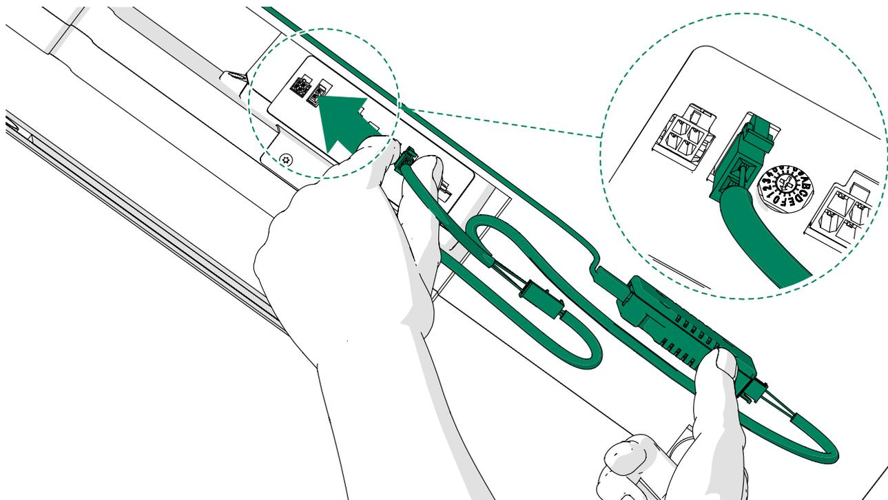
8. Coloque la unidad de 5V con cuidado en el filtro del techo entre las vigas del techo.
