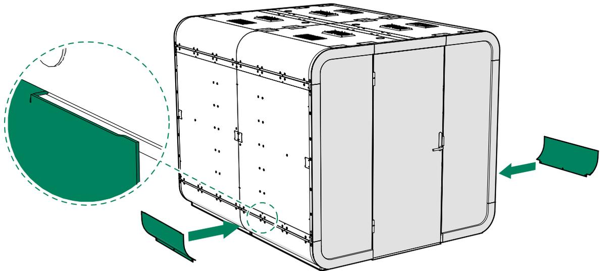
2. Instale las chapas exteriores inferiores (2 unidades en cada lado) en los lados del suelo de la cabina.
