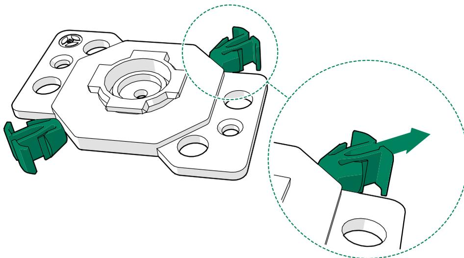
4. Presione los espárragos de plástico retirados para introducirlos en la placa de instalación y deslice el separador GST en ella.
