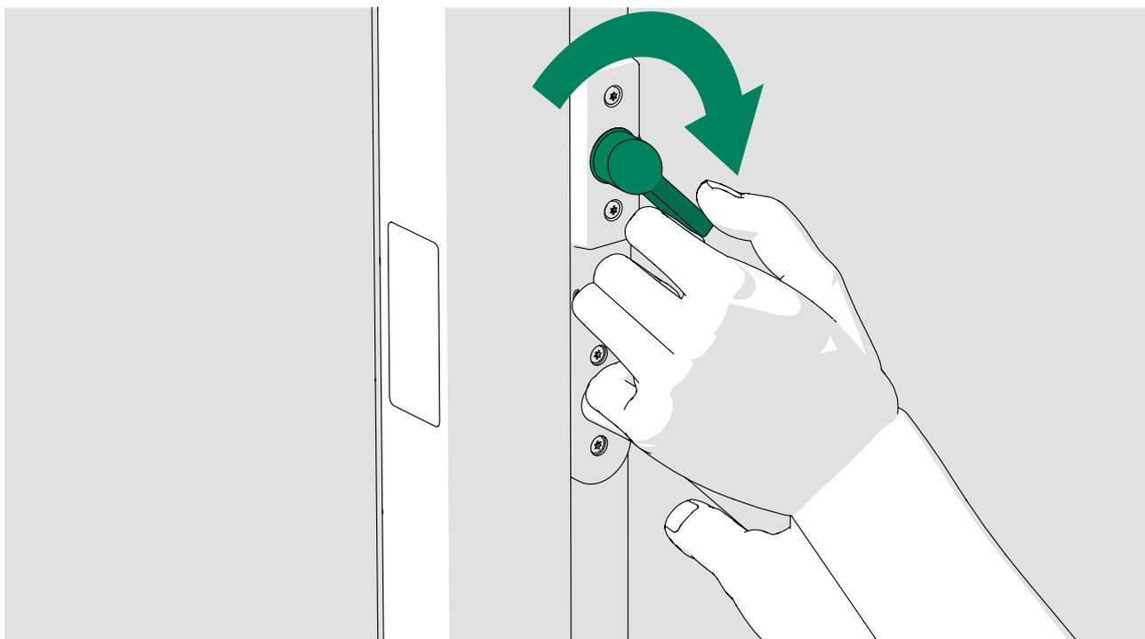
7. Programe el cierre electrónico según las instrucciones del fabricante.
