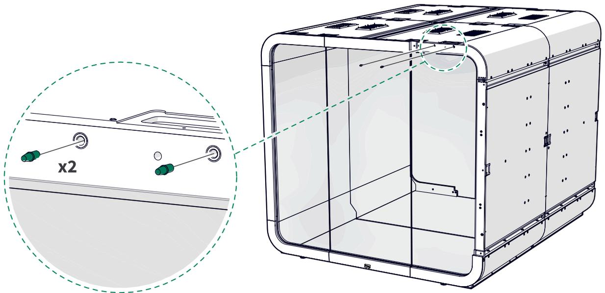
5. Instale el marco de la esquina superior del lado derecho con pernos M8x55 (3 unidades) y arandelas M8 (3 unidades). Utilice una herramienta manual para apretar los pernos.
