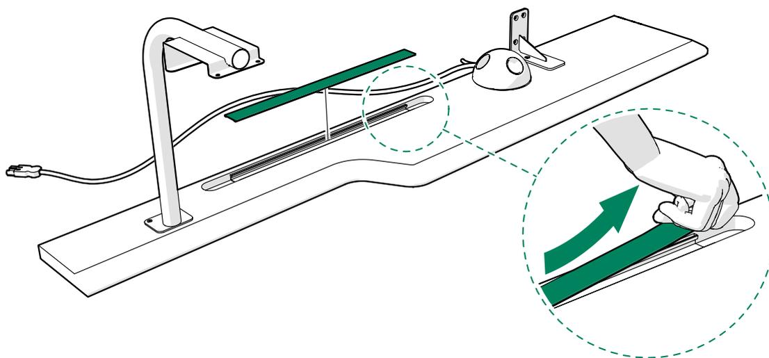
5. Pase el cable de la toma de corriente por el conducto de cables y por la pata de apoyo de la mesa.
