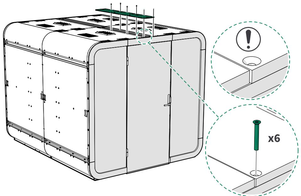
2. Instale el panel de la cubierta del techo en la mitad trasera del techo con tornillos 4x30 (6 unidades).
