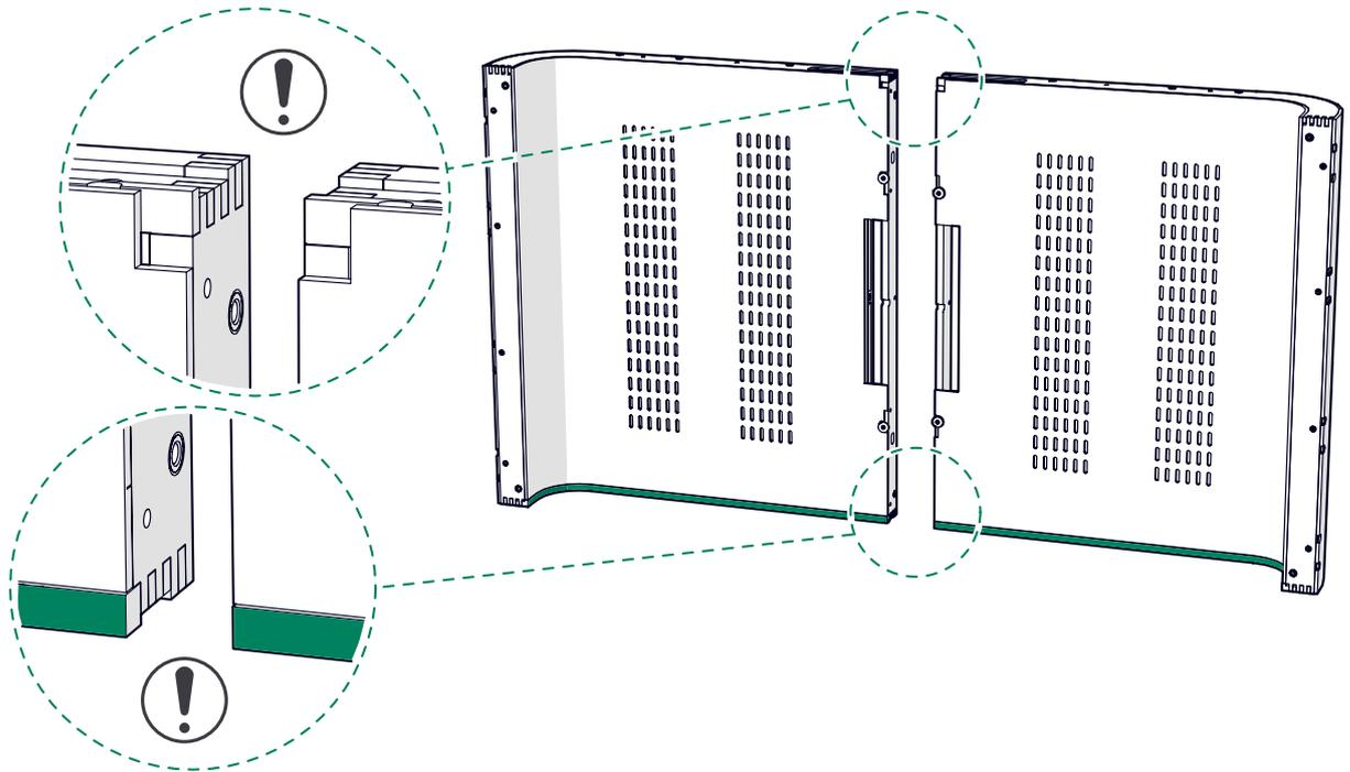
2. Desenrosque los tornillos 4x30 (8 unidades) y retire las placas de la cubierta (8 unidades). Coloque las placas de la cubierta y los tornillos a un lado.
