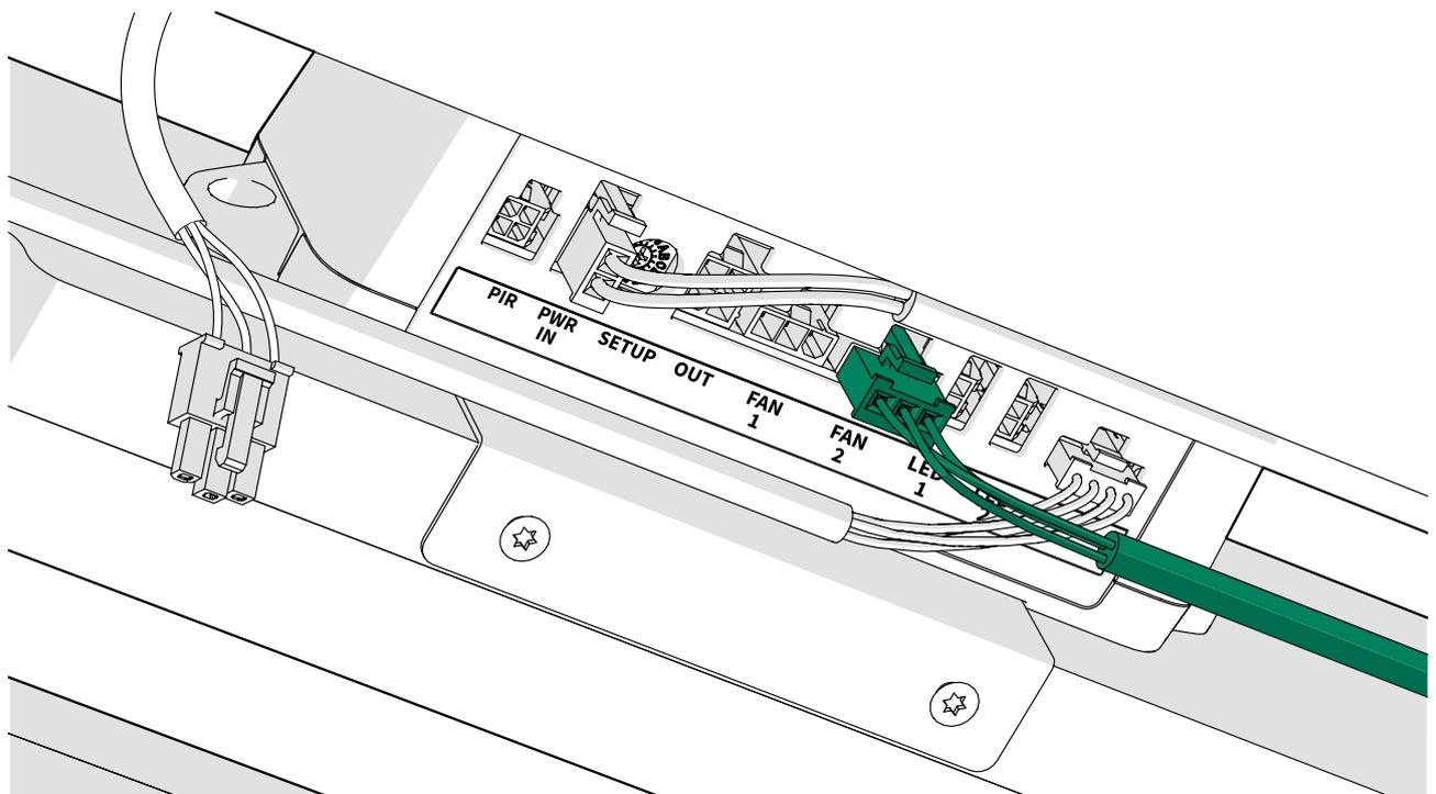
4. Conecte los cables CC del ventilador al alargador corto del ventilador en la parte delantera.
