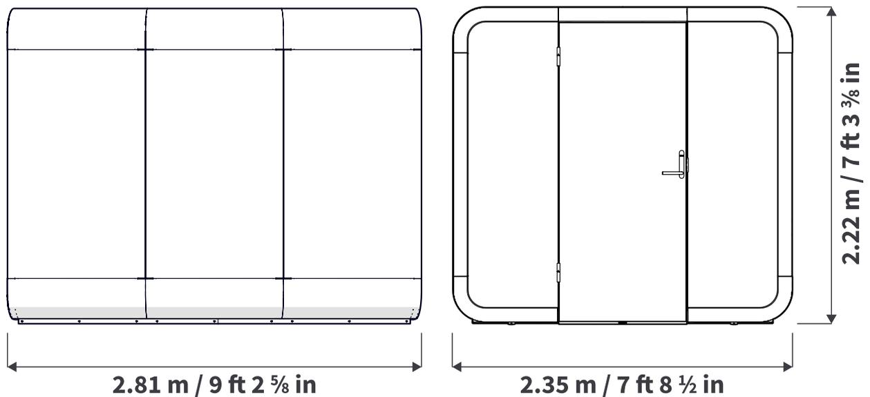
Figura 2: Dimensiones principales de la cabina 2Q
