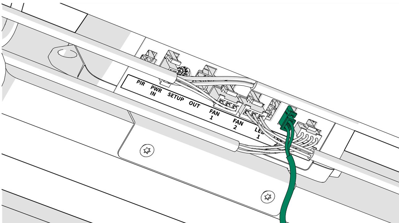
7. Pase el alargador de la luz desde la parte delantera de la cabina hasta la parte trasera y fuera de la abertura de la luz.
