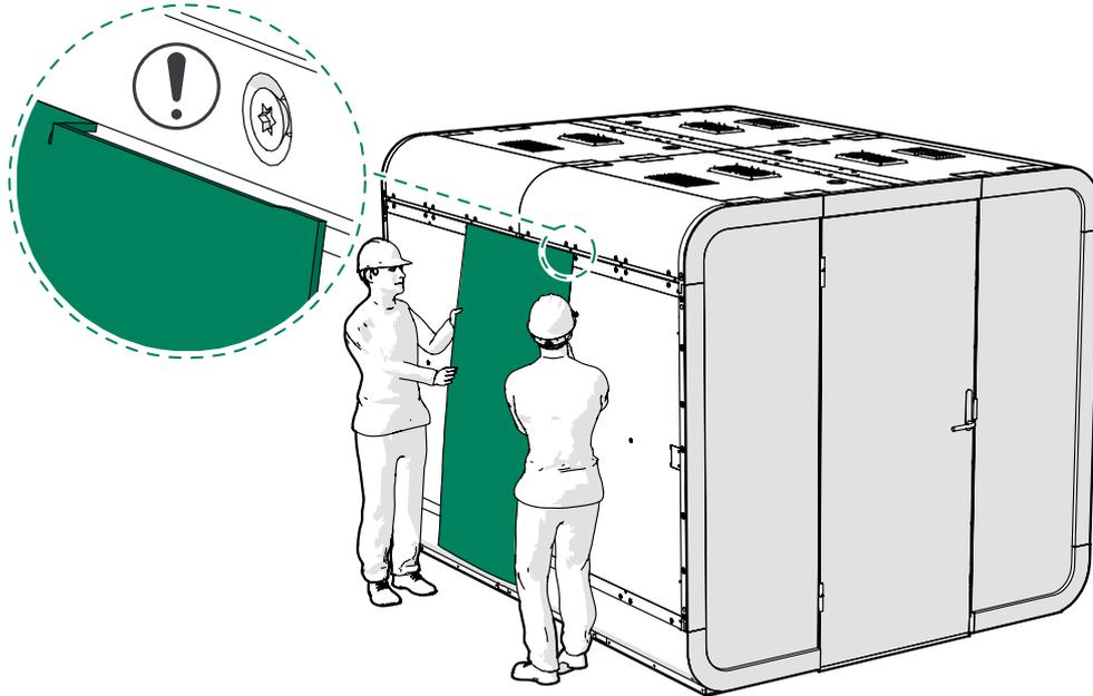
2. Presione la chapa exterior en la ranura superior con una mano y doble la chapa exterior ligeramente hacia afuera con la otra mano. Deslice el borde inferior de la chapa exterior en la ranura de la parte inferior de la pared y presione la chapa exterior en su posición.
