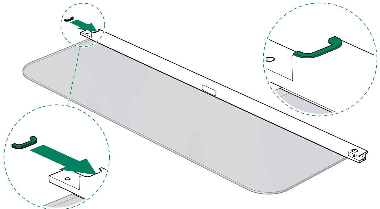
2. Retire la pegatina de plástico que cubre los agujeros para el cable del panel de control y los tornillos del marco del cristal del lado del cerradero.
