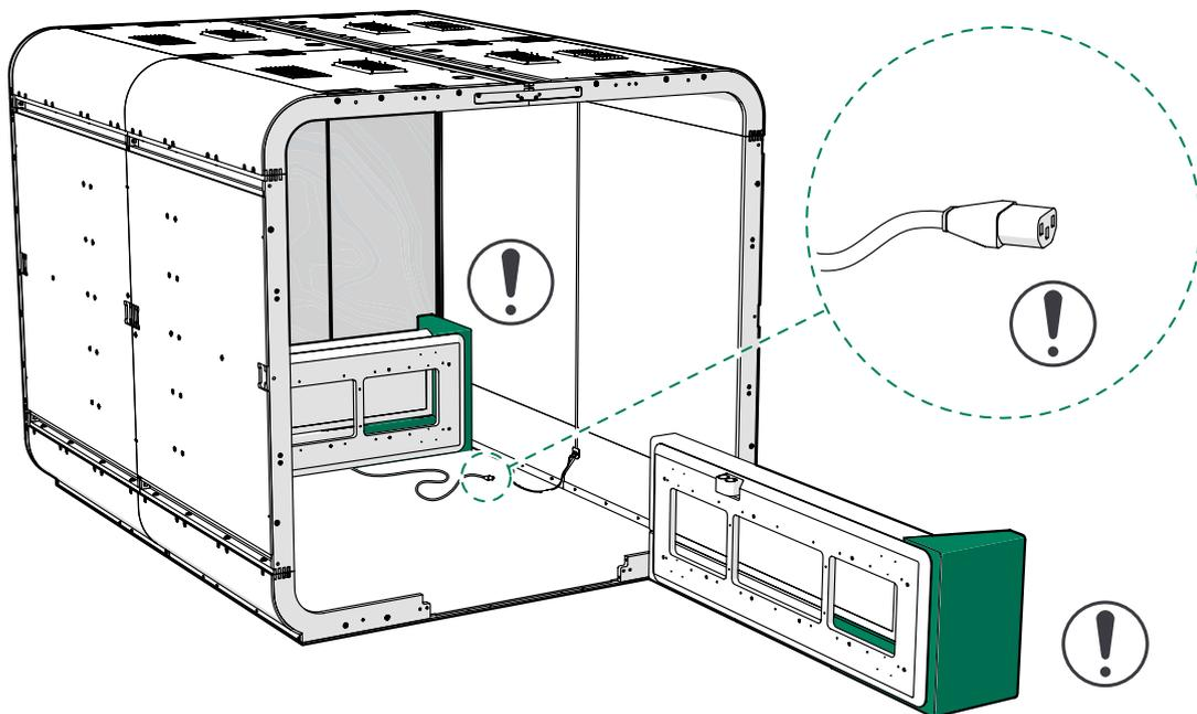
2. Guíe el cable de alimentación principal desde el extremo inferior y hacia fuera de la parte superior de la pata del sofá con dos orificios.
