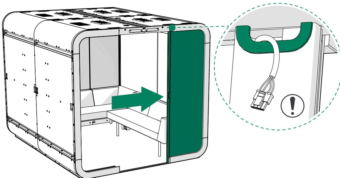
3. Retire el plástico protector aproximadamente 100 mm de la parte superior e inferior del marco de aluminio del cristal del lado de la bisagra.
