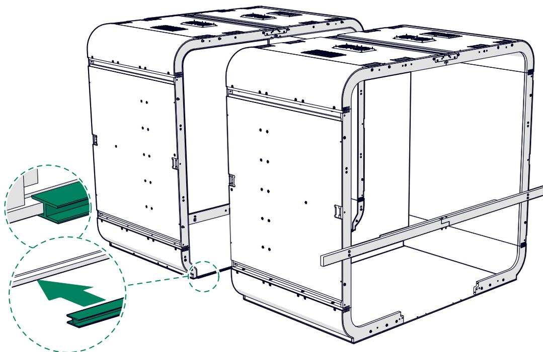
3. Empuje la mitad delantera de la cabina hacia la mitad trasera de la cabina. Compruebe que no haya nada sobre o bajo los tableros de suelo. Utilice la viga de soporte como palanca. Presione el tablero de suelo si no encaja fácilmente en el perfil H. Asegúrese de que las mitades se conecten completamente en todos los puntos.
