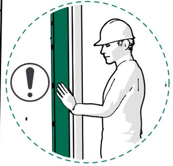
5. Montieren Sie den linken Rahmen mit M8x35-Schrauben (2 Stk.) und M8-Unterlegscheiben (2 Stk.).
