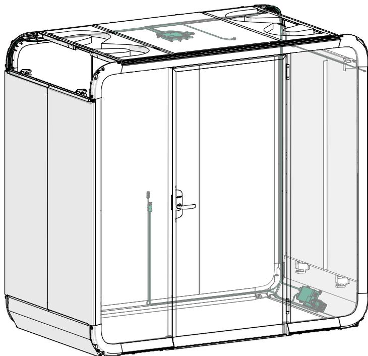
Illustration 4 : Aperçu des raccordements électriques de la cabine
