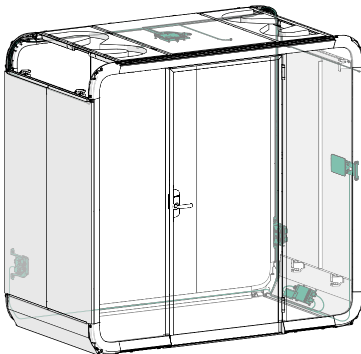
Illustration 4 : Aperçu des raccordements électriques de la cabine
