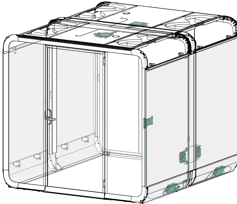
Abbildung 5: Übersicht über die Elektrik der Kabine
