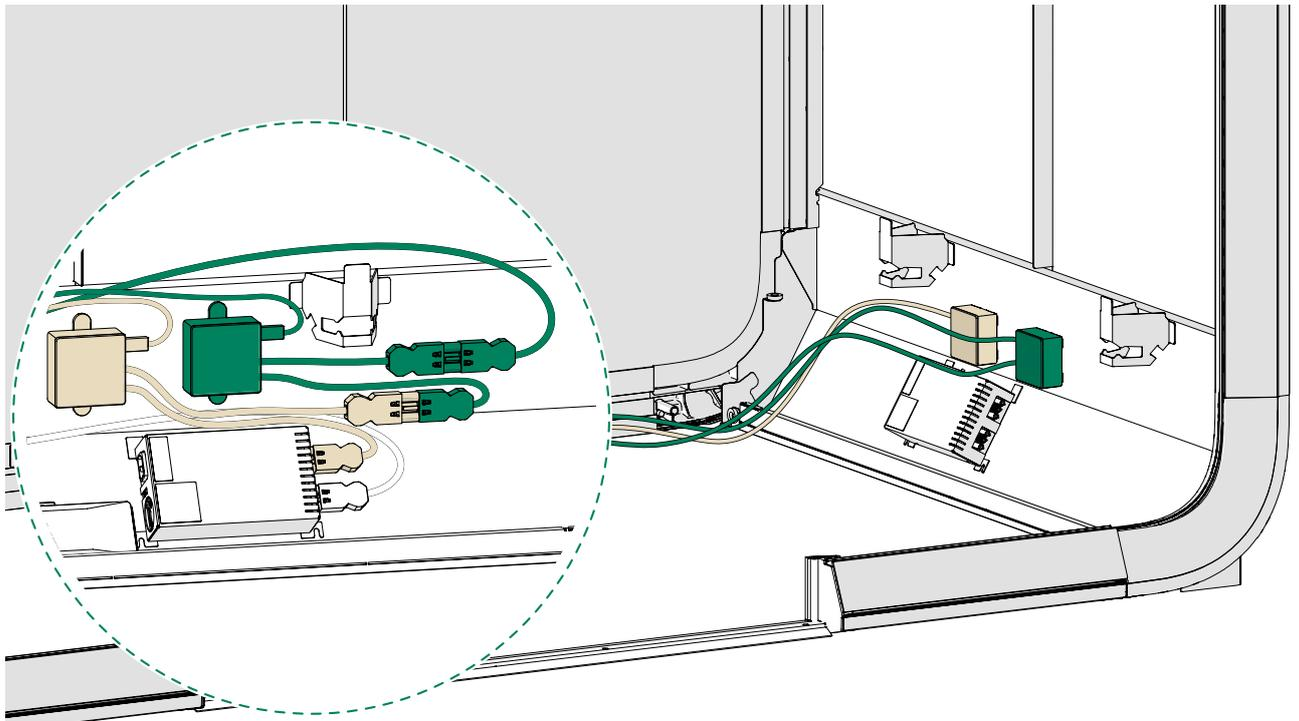
5.7 Kabelkanäle installieren
