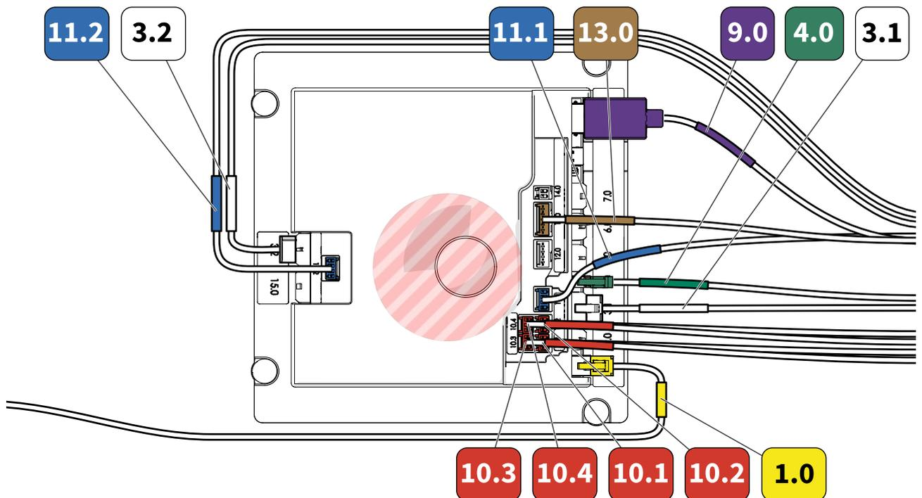
Abbildung 6: Anschlussbeschriftungen auf der Kerneinheit
