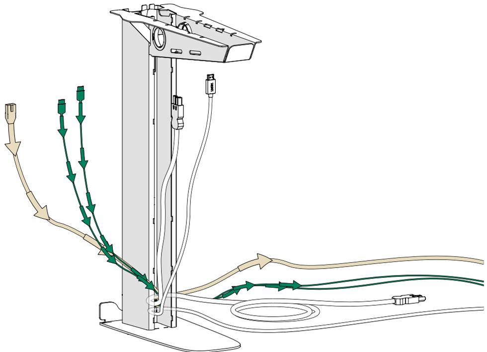
7. Installieren Sie den optionalen USB-C-PD-Ladeanschluss.
