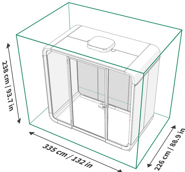
Abbildung 2: Erforderlicher Arbeitsraum bei der Installation
