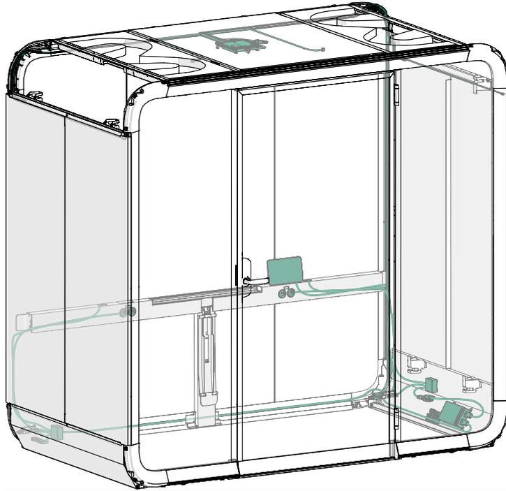
Abbildung 4: Übersicht über die Elektrik der Kabine
