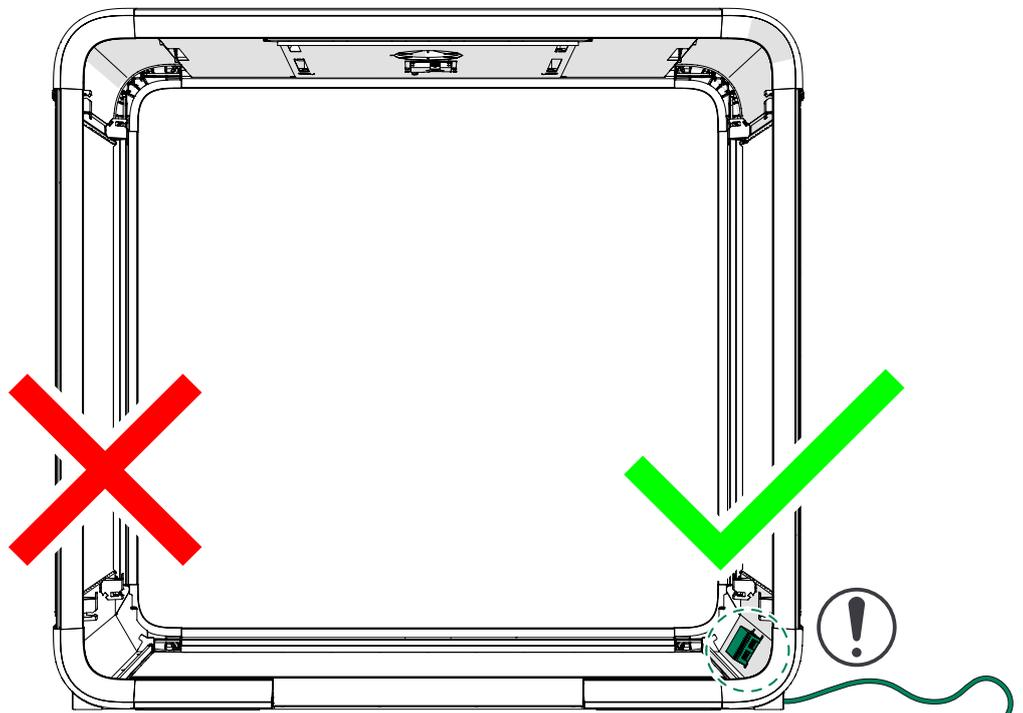
Abbildung 5: Einbauort des Strommoduls
